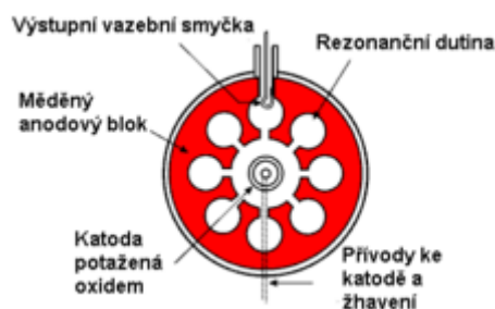
Obr. č. 13 Vnitřní konstrukce magnetronu, převzato a upraveno z [22].
