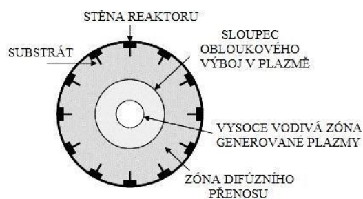
Obr. č. 45 Průřez CACVD reaktoru, převzato a upraveno z [2].
