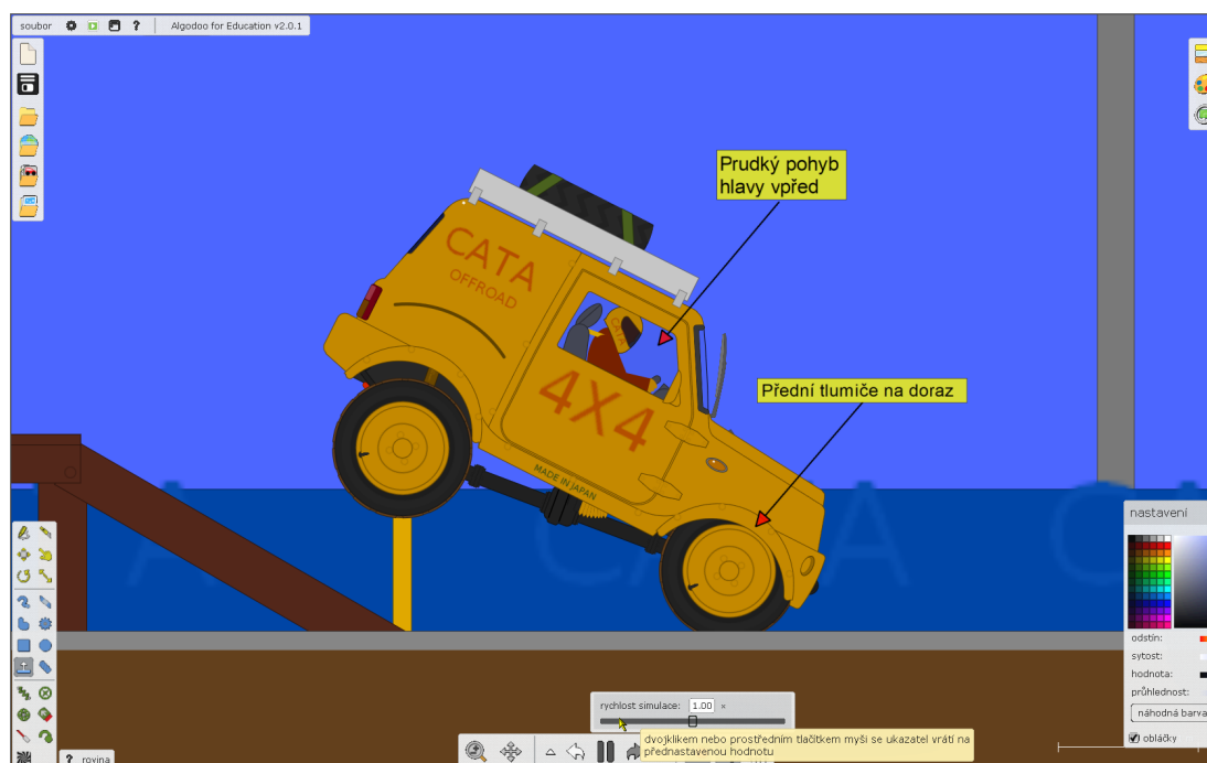
Obrázek 6.7: První fáze dopadu terénního automobilu, zdroj: software Algodoo for Education 2.0.1 , simulace Offroad dostupná z http://www.algodoo.com/algobox/
