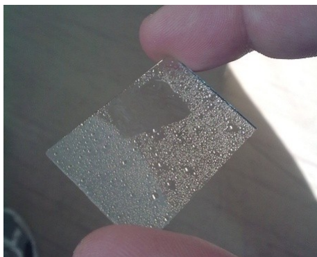
Obr. 21 Dvě různá povrchová napětí na podložním sklíčku
