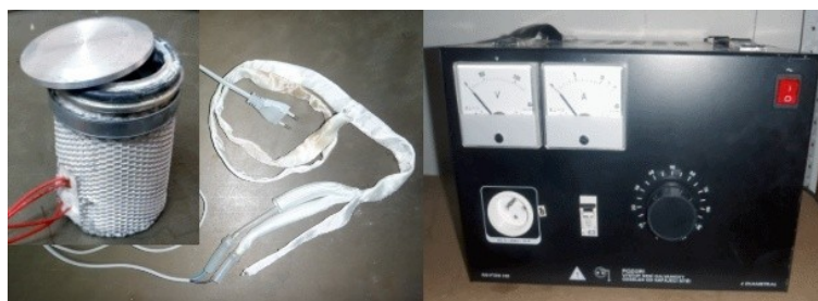
Obr. 13 Výparník, topný pás, Autotransformátor
