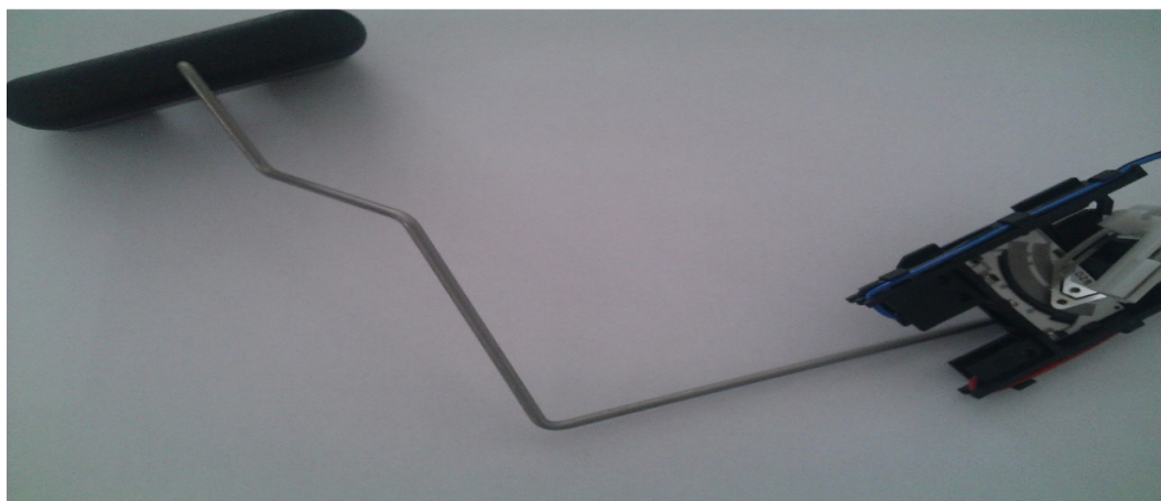
Mechanický plovákový systém s aplikovaným potenciometrem, foto autor.
