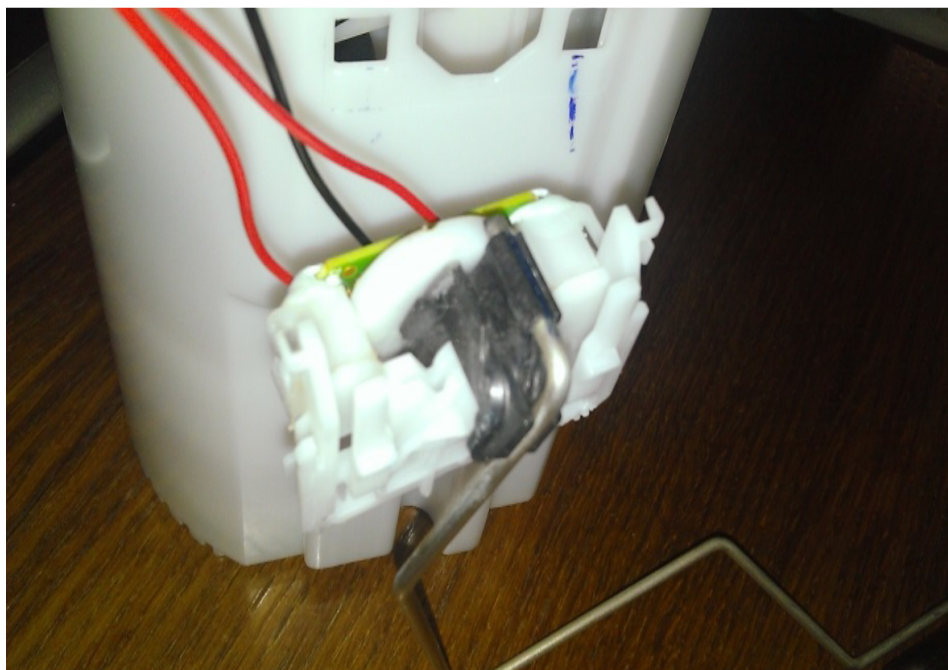
Obr.II.2.6 Kompletní snímač hladiny paliva, foto autor
