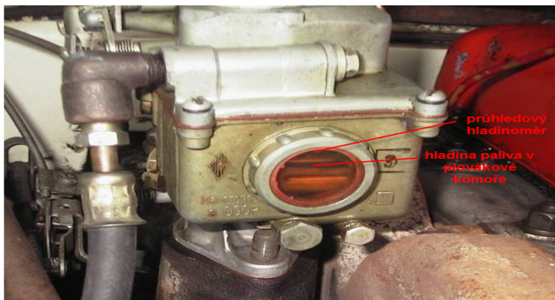
Obr. I.2.2 Průhledový hladinoměr v plovákové komoře karburátoru K-124 pro osobní vůz značky Volha, převzato a upraveno z [4].
