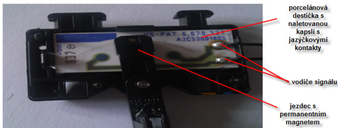
Obr. I.3.5.2. Magnetický snímač s jazýčkovým relé, foto autor.
