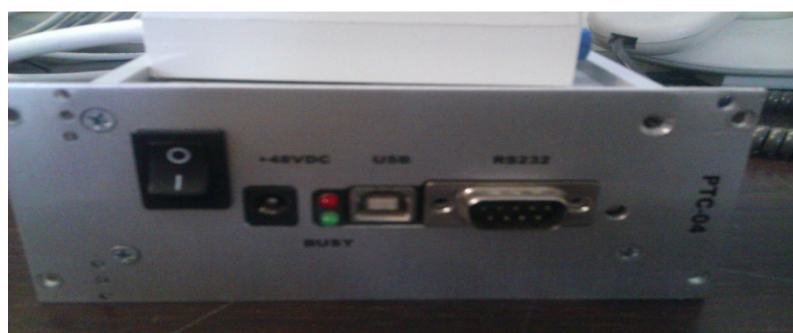
Obr.II.2.10 Programátor PTC-04 od firmy Melexis., foto autor.
