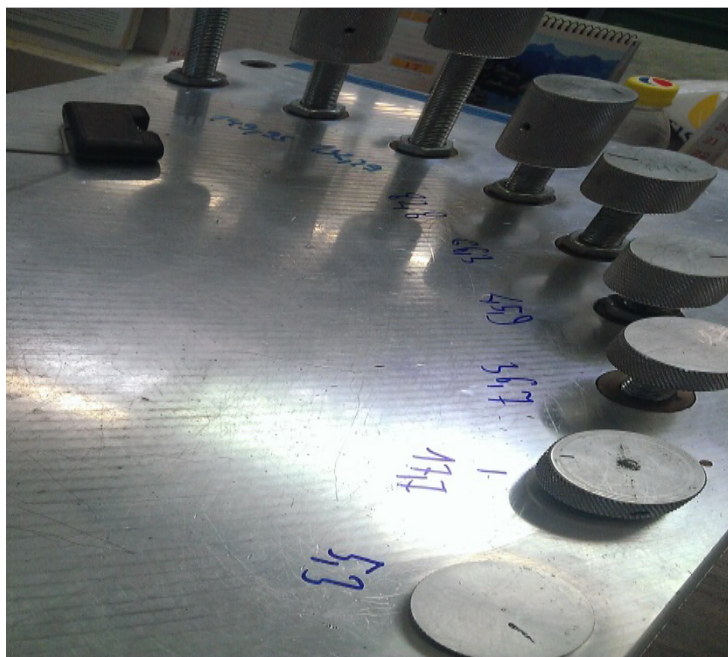
Obr.II.3.1 Zkušební přípravek – s nastavitelnými stupni pro polohování plovákové páky, foto autor.
