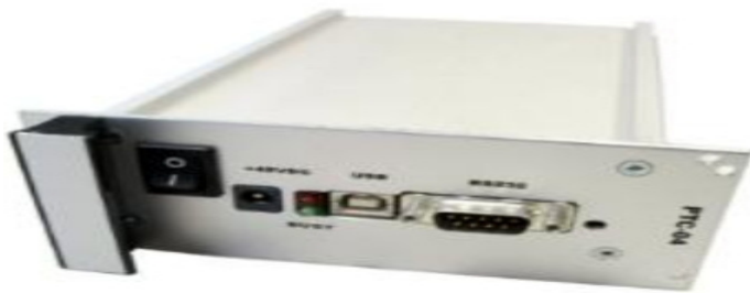
Obr.I.6.6 programátoru PT-C04 pro programování Hall-čipů, převzato a upraveno z [31].
