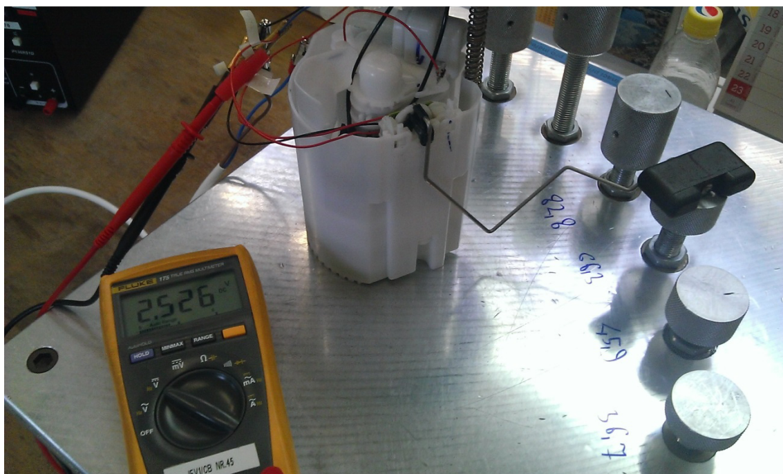
Obr.II.3.7 Výstupní napětí na pátém dorazu, foto autor.
