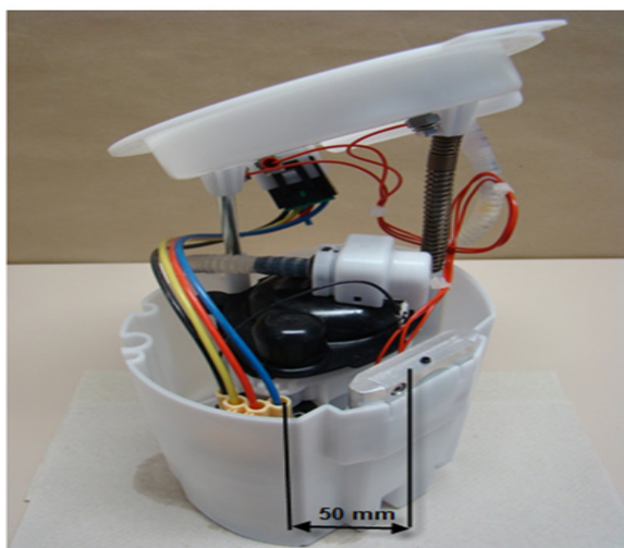
Obr.II.5.13 Foto čerpadlového modulu s elektronicky komutovaným čerpadlem, s laskavým svolením Ing. P. Tesaře, převzato a upraveno z [34].
