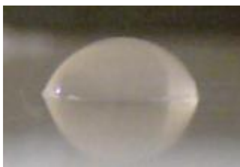
Obrázek 2.10: Parametry pro určení velikosti kontaktního úhlu [10]
