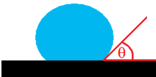
Obrázek 2.3: Vymezení kontaktního úhlu na rozhraní tří skupenství
