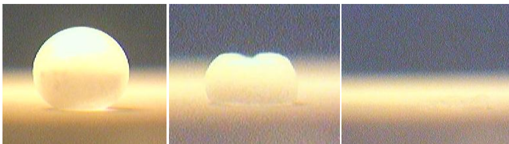
Obrázek 3.6: kapka po nanesení Obrázek 3.7: Postupné vsakování Obrázek 3.8: Konec měření
