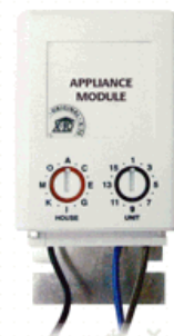
Obr. č. 32 – Spínací modul (vývodový) [28]
