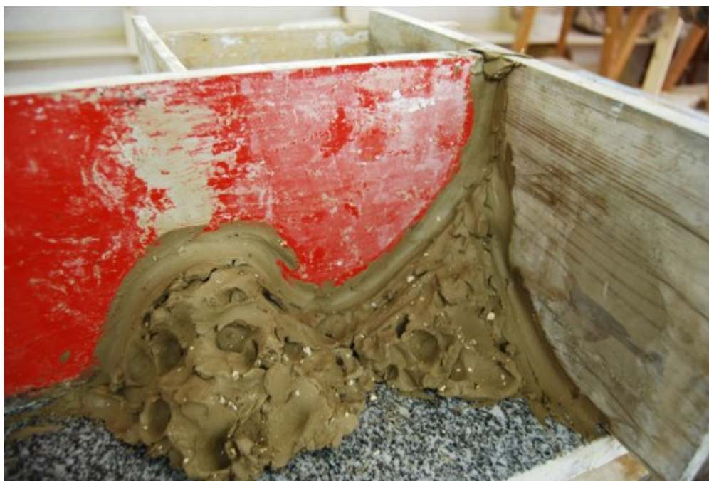
Obr. 23 Místa, kde se vytvoří vysoký tlak (naproti kolmé dřevěné desce)
