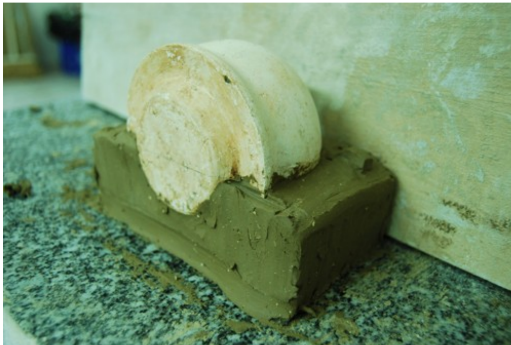
Obr. 20 Polovina modelu zapuštěného do hlíny
