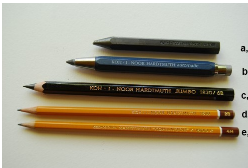
Obr. 32 Různé druhy tužek: a, grafitová tužka v laku; b, mechanická tužka s automatickým posuvem tuhy; c, grafitová tužka 6B; d, e, grafitová tužka 1500 2B
