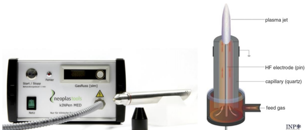
Obrázek 20: Atmospheric pressure plasma jet: Příklad pro aplikaci, schéma.
