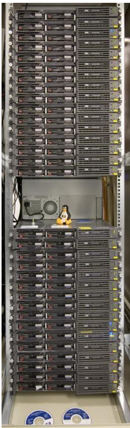
Obr. 16 Výpočetní uzel Skirit - uzly č. 17 až 48 (celkem 32), převzato a upraveno z [19]
