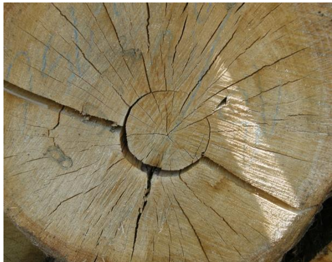
Obr. 14 – Odlupčivá trhlina (uprostřed)
