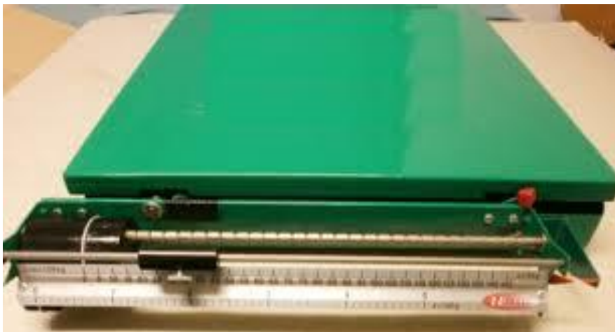
Obr. 4 Mechanická úlová váha
