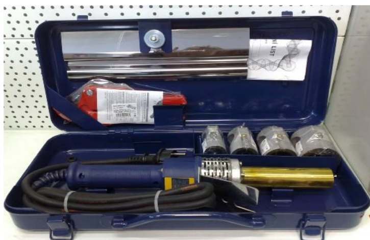
Obr. č. 16 Polyfúzní svářečka pro spojování plastového potrubí [9]
