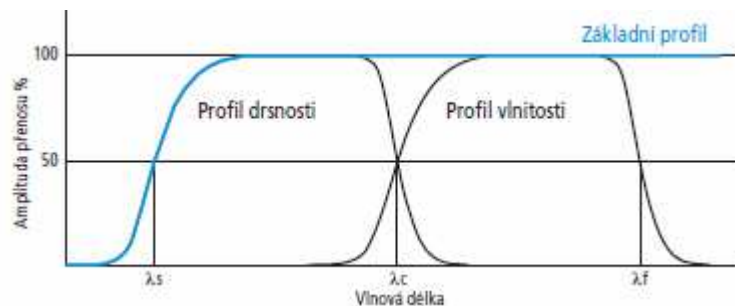
Obr. 7: Přenosová charakteristika profilu drsnosti a vlnitosti (převzato z [7])
