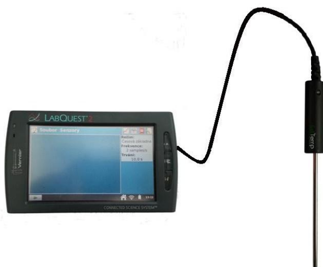
Obr. č. 5.3.4.1.: Připojení teploměru k dataloggeru
