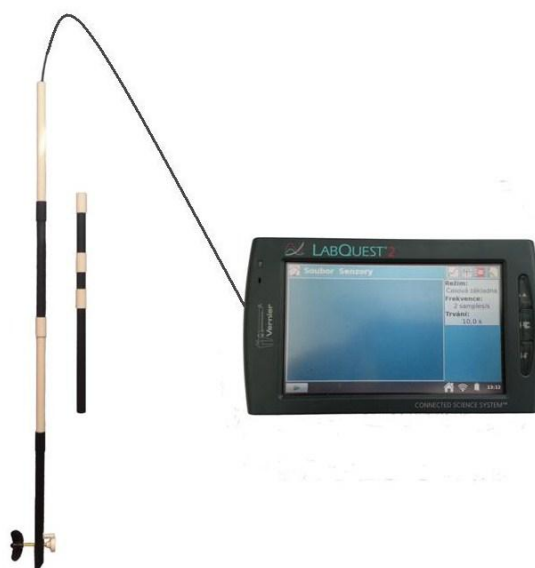
Obr. č. 5.3.1.1.: Připojení průtokoměru k dataloggeru
