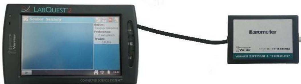
Obr. č. 5.2.1.: Připojení barometru k dataloggeru
