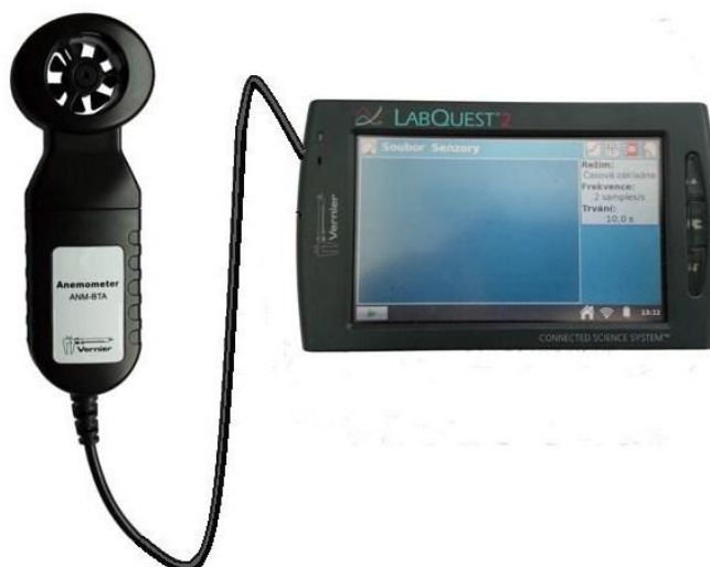
Obr. č. 5.3.2.1.: Připojení Anemometru k dataloggeru
