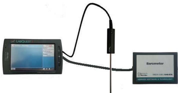
Obr. č. 5.4.1.: Společné připojení teploměru a barometru k dataloggeru
