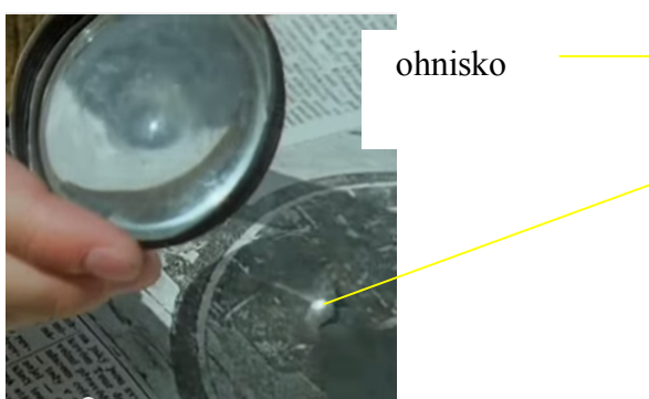
3. 48 Soustředění paprsků pomocí lupy.
