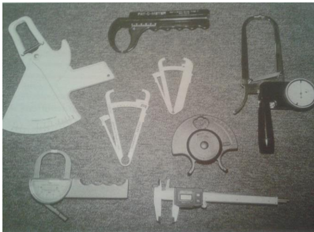
Obrázek 2. Kaliper - měření kožních řas (Heyward, 2002, 174).
