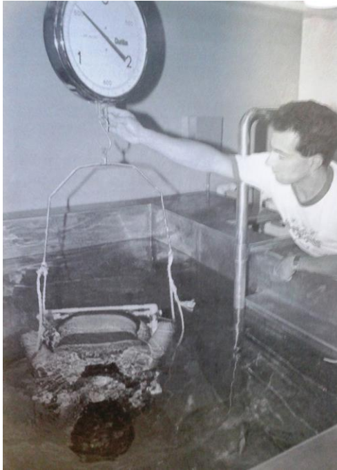
Obrázek 1. Hydrostatické vážení (Heyward, 2002, 165).
