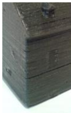
Obr. 3 Detail hrany modelu z technologie FDM
