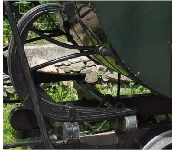
Obr. 3.1.33 Osobní vůz koněspřežky Hanibal detail odpružení Pferdeeseisenbahn-Kirschbaum
