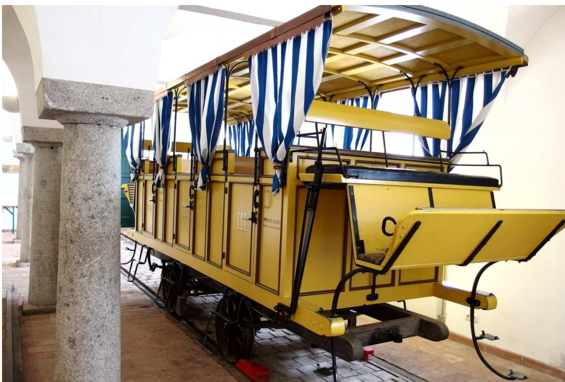
Obr. 3.1.36 Replika osobního vozu koněspřežky „J. A. Gerstner“ III. třídy pro 24 osob, die Pferdeeisenbahn-Museum Kerschbaum
