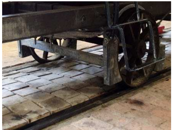
Obr. 3.1.38 Detail odpružení vozu III. třídy die Pferdeeisenbahn-Museum Kerschbaum
