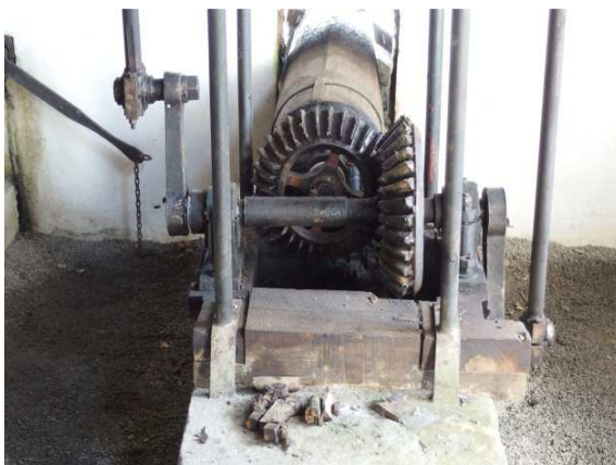
Obr. 4.2.9 Kuželové soukolí s klikovým mechanismem pro pístové měchy
