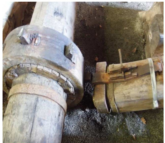
Obr. 4.2.7 Osa vodního kola s kolíkovým nákrůžkem a botkou
