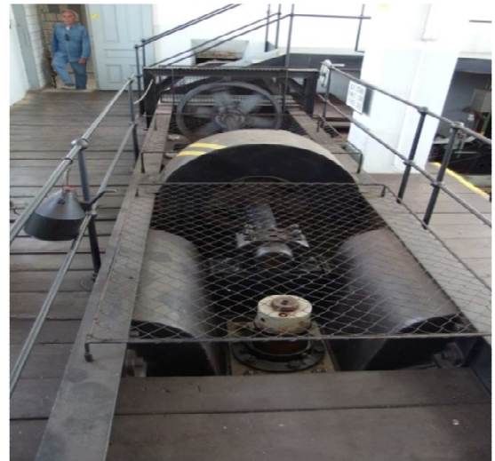
Obr. 4.4.8 Detail zvonového kola turbíny Obr. 4.4.9 Detail koncového uložení turbíny
