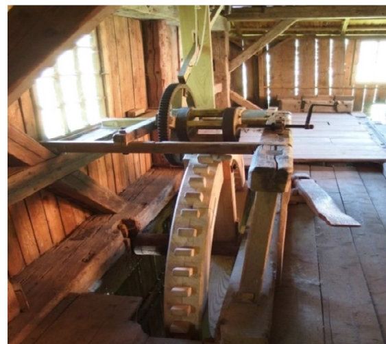
Obr. 4.1.7 Palečnicové kolo posuvu vozíku
