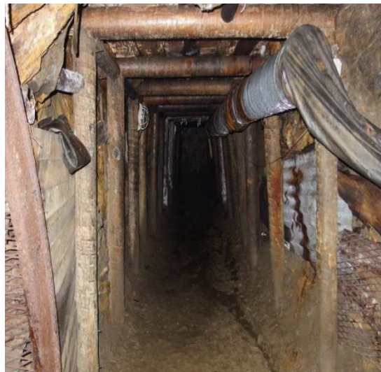
Obr. 2.3.2 Hlavní štola s ocelovými výztuhami Obr. 2.3.3 Překop vyztužený výdřevou
