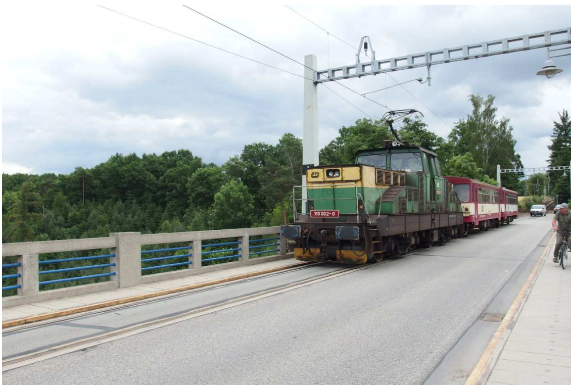
Obr. 3.3.7 Elektrická lokomotiva typu E 423.001, která zajišťuje běžný provoz na trati, na Bechyňském mostě
