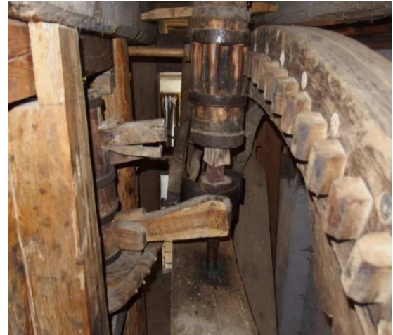
Obr.4.3.9 Palečnicové kolo, pastorek a Vačka
