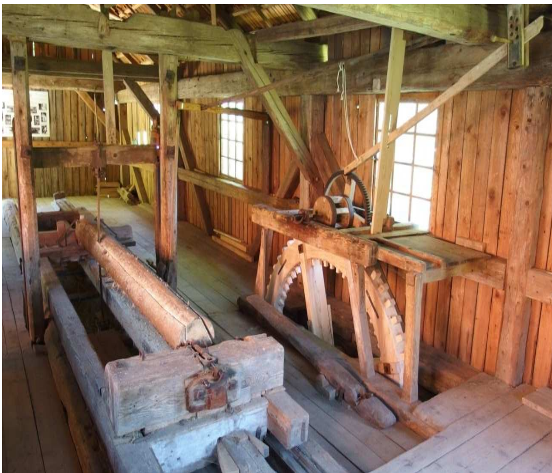
Obr. 4.1.1 Řezání kmenu na rámové pile v Peníkově
