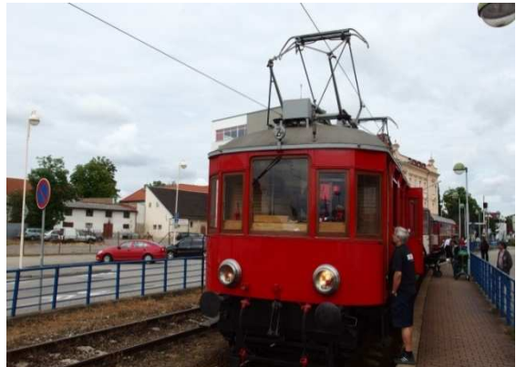
Obr. 3.3.1 Původní motorový vůz elektrické dráhy M 400.001, dnes v majetku ČTM, na nádraží v Bechyni
