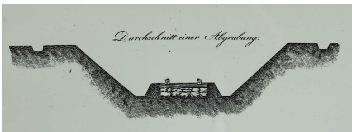
Obr. 3.1.44 Zářezy byly až 9 m hluboké, násypný úhel boků se pohyboval 45^{\circ} až 60^{\circ} , naučná stezka „Koněpřežní železnice“
