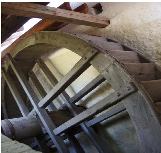
Obr.4.3.2 Vodní kolo s vantroky
