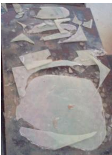
Obrázek 29 Velká plocha skleněného substrátu po žhání
