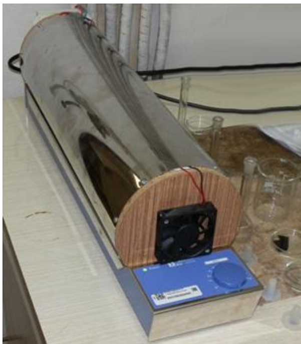
Obrázek 46 Vzorky v AO7 překryté UV lampou
