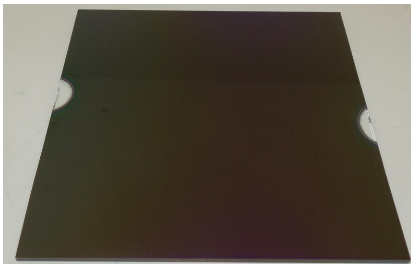
Obrázek 26 Substrát (skleněná destička) s vrstvou z procesu č. 10
