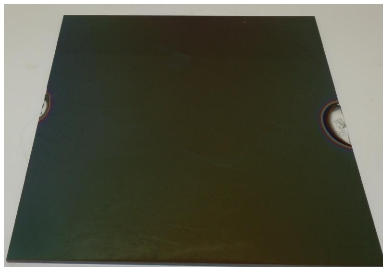
Obrázek 19 Substrát (skleněná destička) s vrstvou z procesu č. 2
