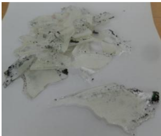
Obrázek 28 Popraskané vyžíhané skleněné substráty
