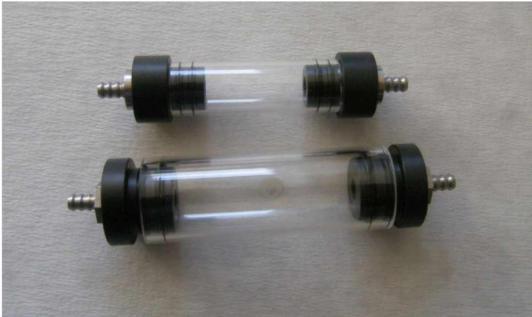
Obr. 8. – Skleněné komůrky používané k měření v respirometru – na obou koncích jsou utěsněny plastovými zátkami. Horní komůrka je o objemu 8 ml a dolní komůrka je o obsahu 14,5 ml.
