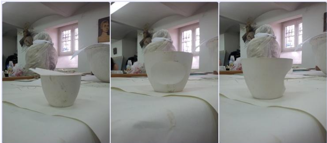
Obr. 2: Výsledný model hrnku, ze sádrového kruhu, s hotovou výdutí
