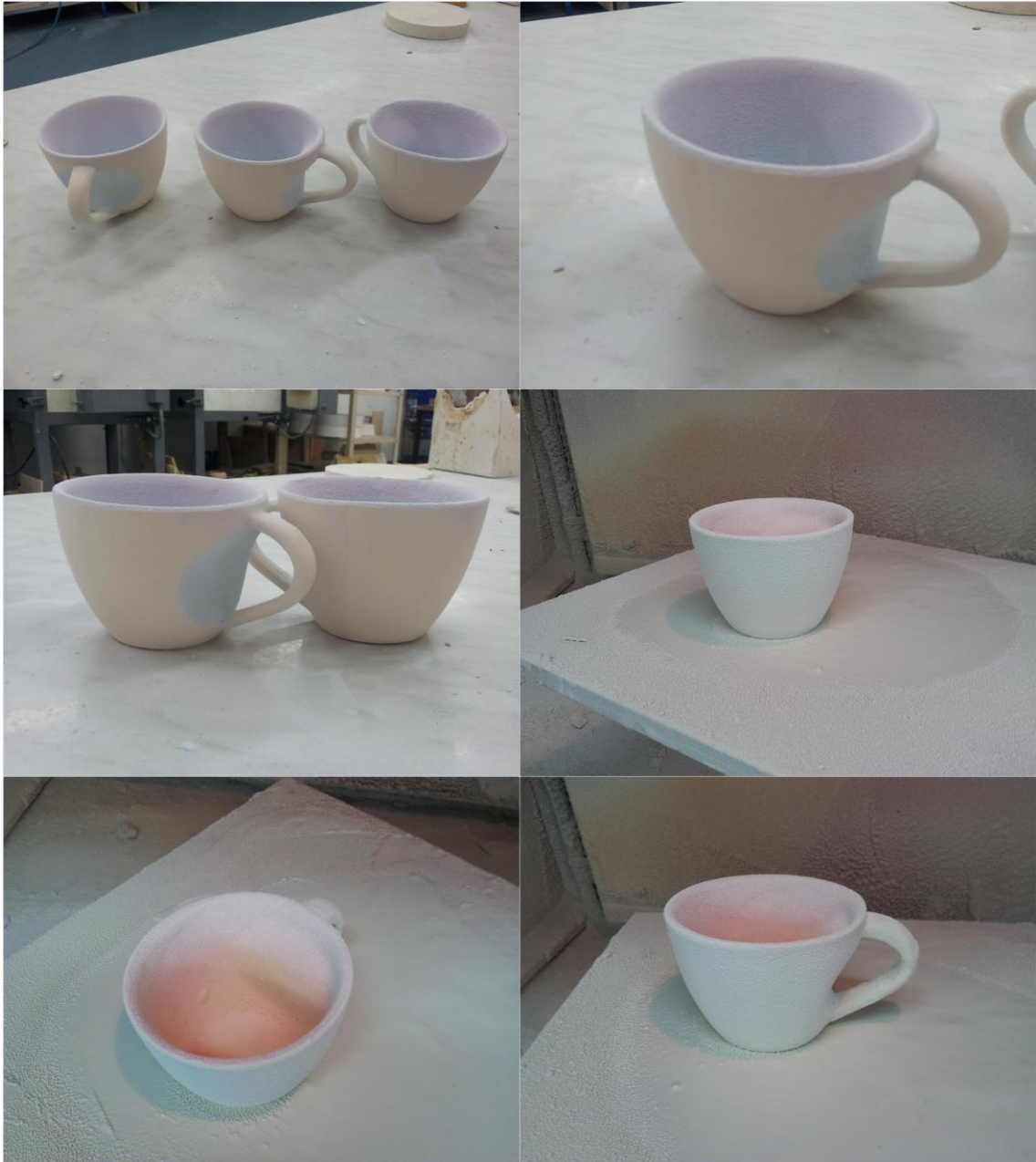
Obr.7 – V procesu glazování
