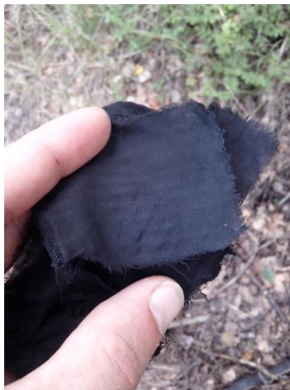
Obrázek 20: Hotová přepálená zuhelnatělá látka bez přístupu vzduchu
