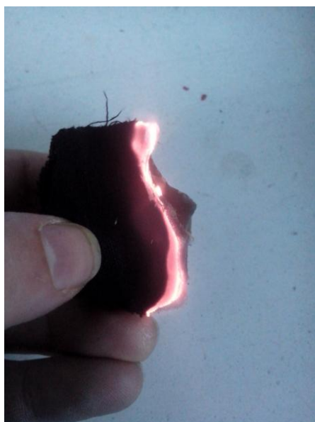
Obrázek 21: Zkouška zachycení jiskry do zuhelnatělé látky
