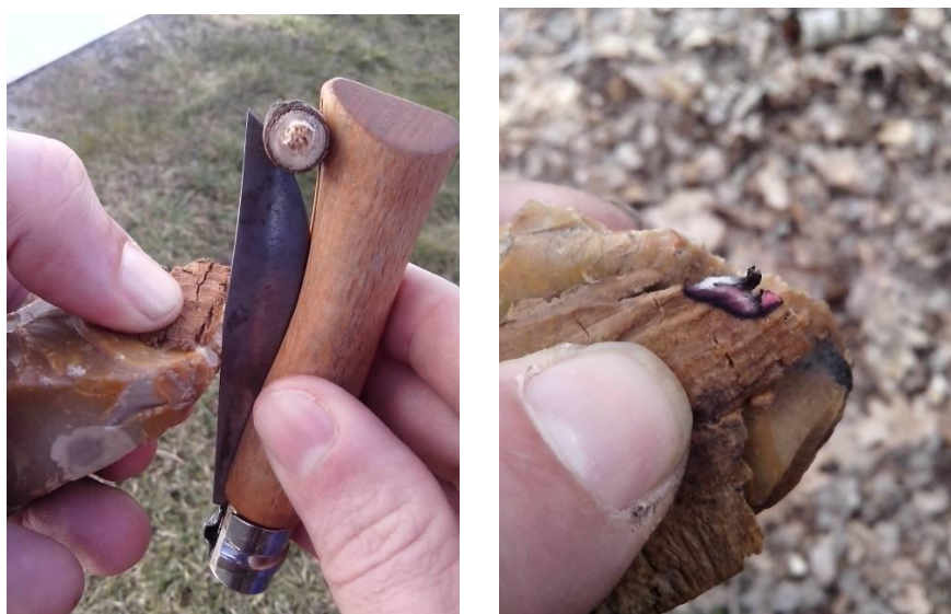
Obrázek 103: Vlevo – křesání pomocí nože s uhlíkaté oceli, vpravo – zachycená jiskra do troudnatce
