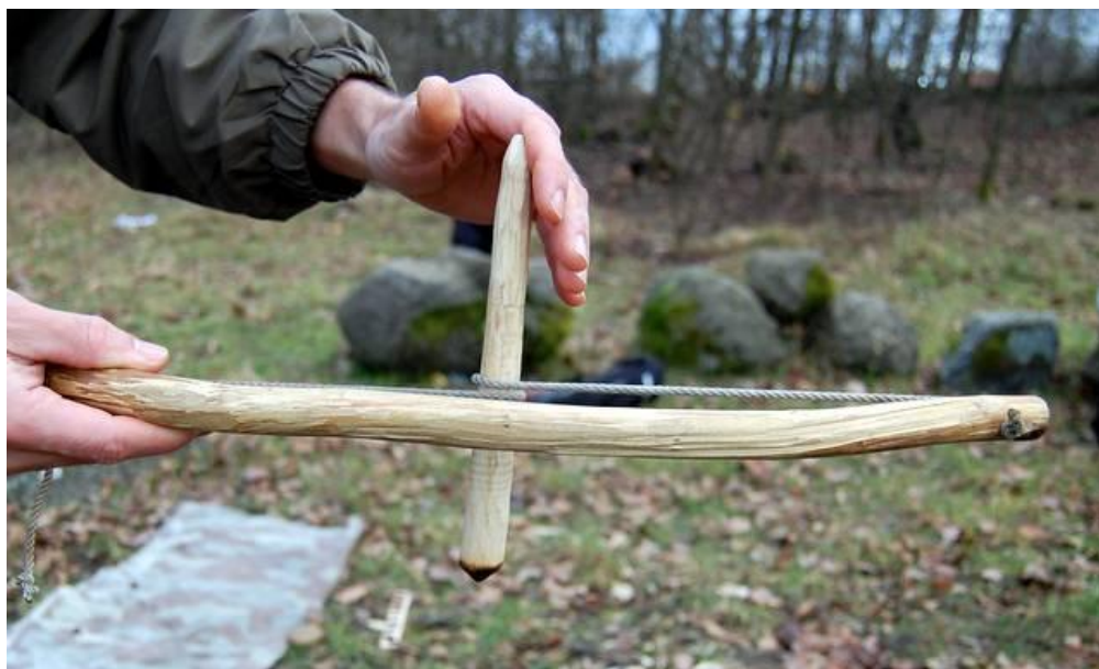
Obrázek 61: Správně upnutý vrták v tětině luku
