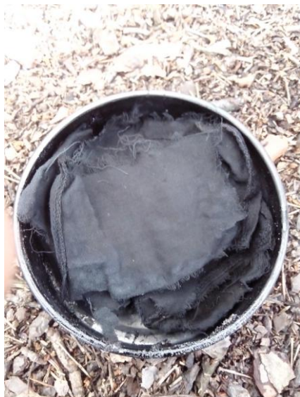
Obrázek 20: Hotová přepálená zuhelnatělá látka bez přístupu vzduchu
