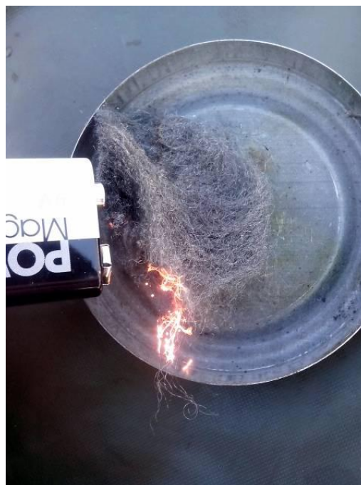
Obrázek 113: Nahoře – váček s ocelovou vatou a 9 voltovou baterií, vlevo dole – ocelová vata, vpravo dole – vznícení ocelové vaty za pomoci elektrické energie
