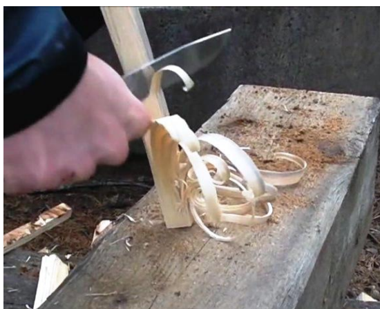
Obrázek 33: Vlevo – příprava materiálu na chlupaté polínko, vpravo – řezání jemných hoblin
