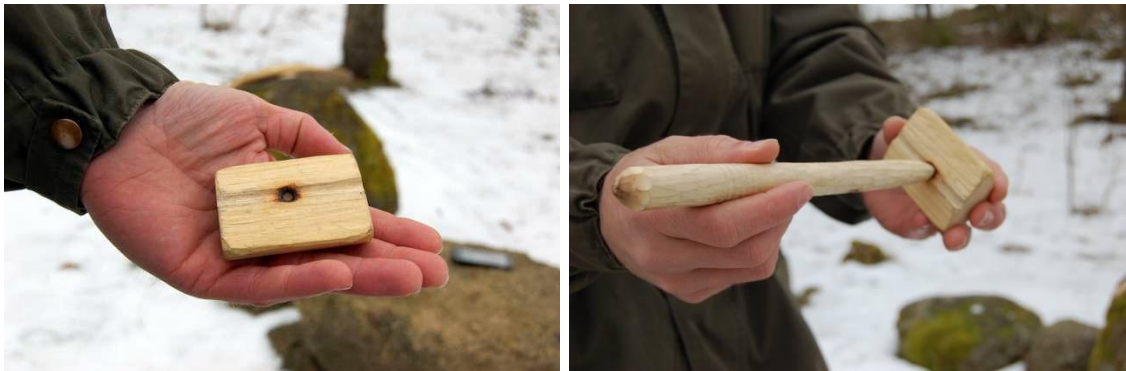
Obrázek 55: Vlevo – přítlačný díl s jamkou, vpravo – zkouška vrtáku s přítlačným dílem
