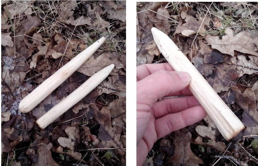
Obrázek 49: Vlevo – vyrobený vrták a použitý vrták, vpravo – detail použitého vrtáku
