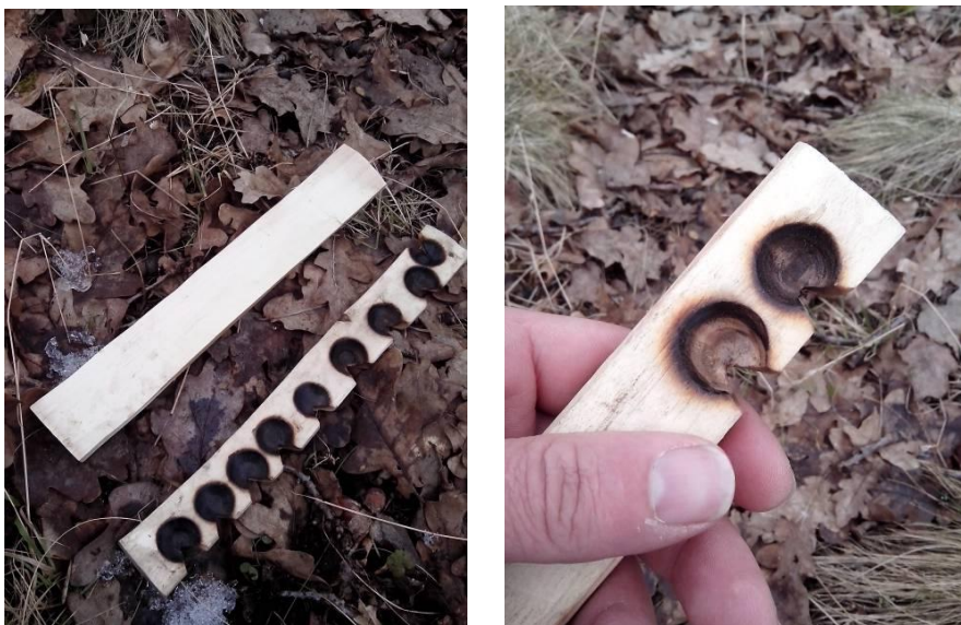
Obrázek 50: Vlevo – vyrobená ohňová deska a použitá ohňová deska, vpravo – detail vyvrtané jamky vrtákem
