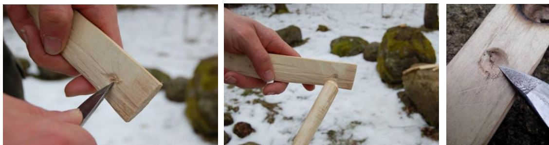
Obrázek 58: Vlevo – vytvoření jamky nožem v ohňové desce, uprostřed – zkouška vrtáku, vpravo – ukázka hotové jamky
