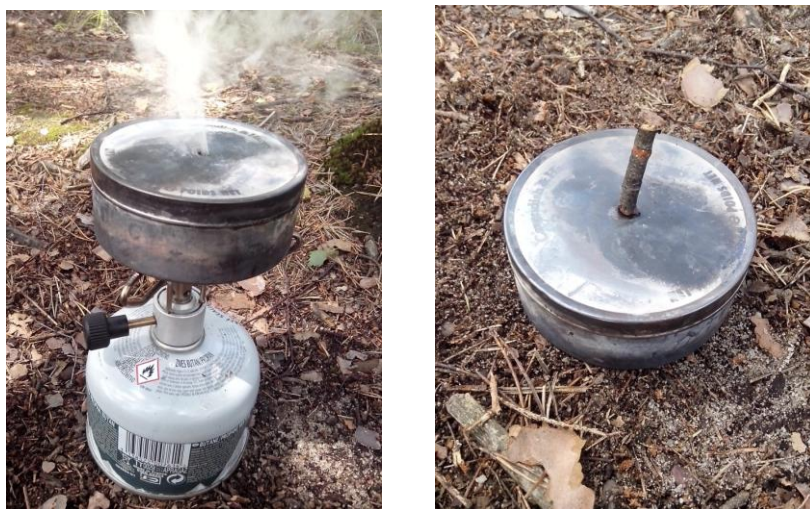
ObrĚzek 19: Vlevo: - zahĚjĚnĚ procesu pĚřepĚlenĚ lĚtky na hořĚku – ůnik kouře, vpravo – zamezenĚ pĚřĚstupu vzduchu – ucpĚnĚ dĚry
