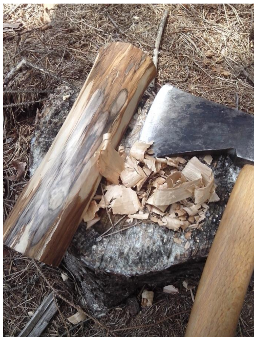
Obrázek 78: Vlevo – opracování desky sekerou, vpravo – hotová ohňová deska
