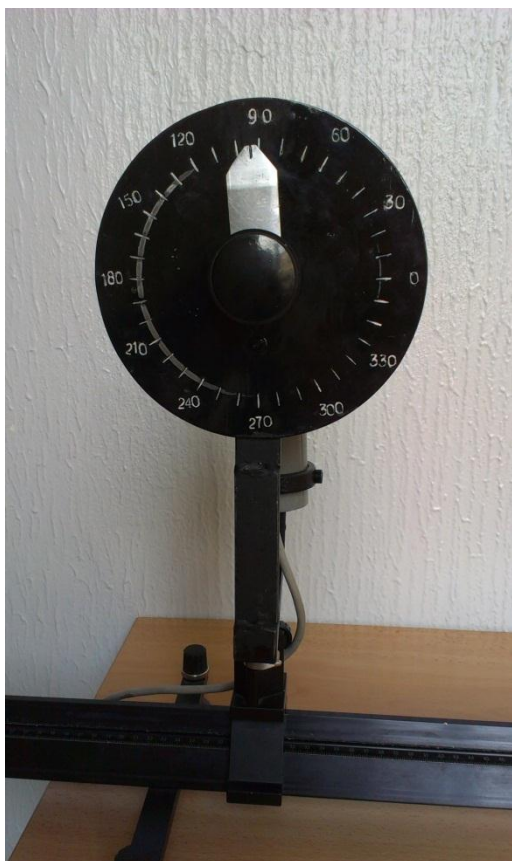
Obrázek 8.1.2: Držák s otočnou žárovkou a úhломěrnou stupnicí
