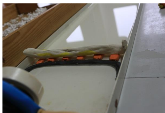
Obr. 4.7 Rozvrstvení toku pomocí plastelíny
