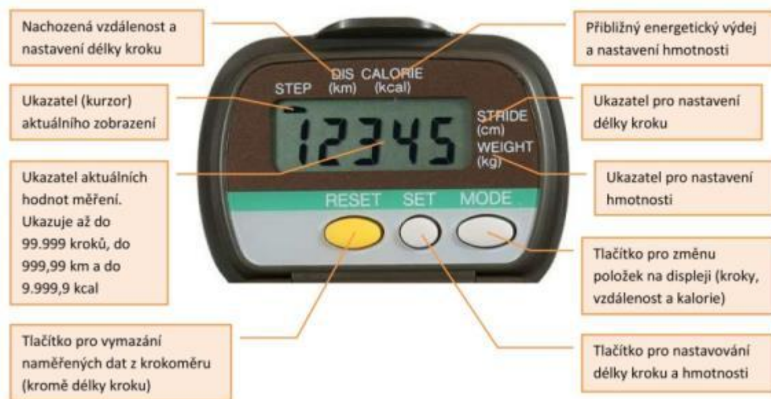
Obrázek 2: Krokoměr Yamax Digiwalker SW-700 s popisem ovládacích prvků (radostz pohybu.cz, online)
