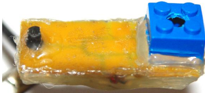
Obrázek 26 - Zhotovené čidlo měřiče rychlosti proudění s PTC termistory.
