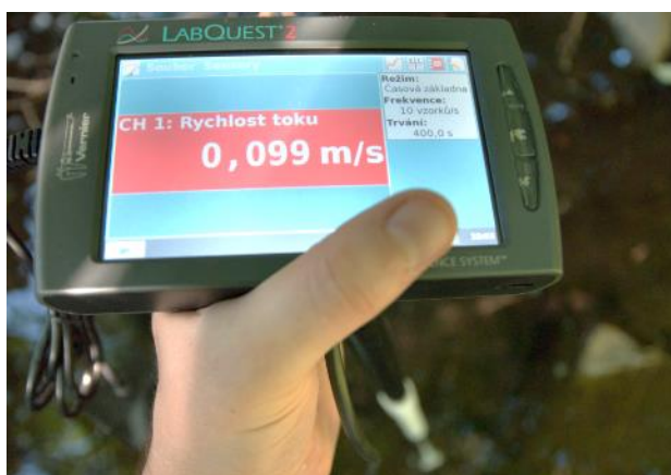
Obrázek 44 - Hodnoty naměřené oběma měřiči po kalibraci.
