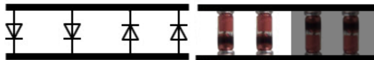
Obrázek 17 - Realizace senzoru měřiče rychlosti proudění s diodami. Šedá část vpravo značí bariéru, která zabraňuje proudění. Obrázky diod převzaty a upraveny z [23].
