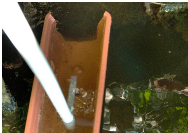
Obrázek 43 - Kalibrace měřiče rychlosti proudění v upraveném truhlíku.
