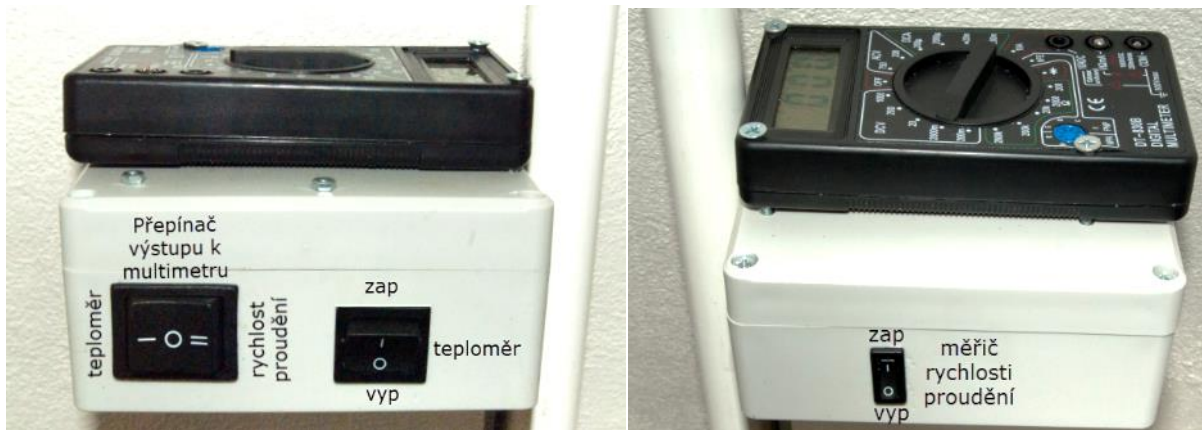
Obrázek 40 - Boční pohledy na zhotovenou krabičku mobilního měřiče. Vlevo vypínač teploměru a přepínač výstupu k multimetru, vpravo vypínač měřiče proudění.
