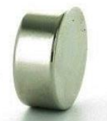
Obrázek 27 - Neodymový magnet. Převzato z [28].
