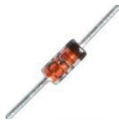
Obrázek 19 - Dioda 1N4148. Převzato z [24].
