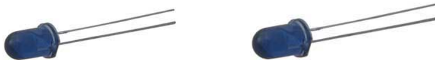
Obrázek 30 - Vlevo je infračervená LED dioda L53F3BT a vpravo je fototranzistor L-53P3BT. Převzato z [29, 30].
