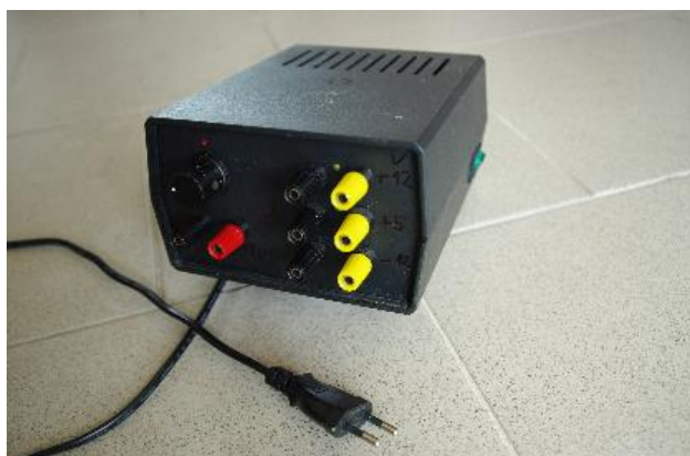
Obrázek 15 - Vlastnoručně vyrobený zdroj symetrického napětí.
