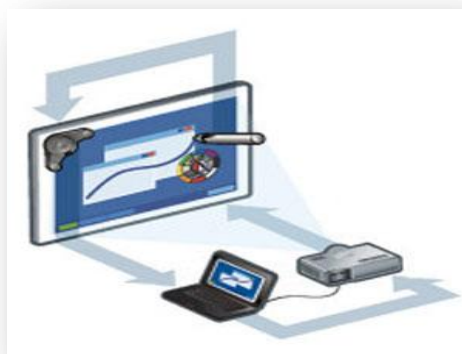
Obr. č. 1 Schéma fungování interaktivní tabule
