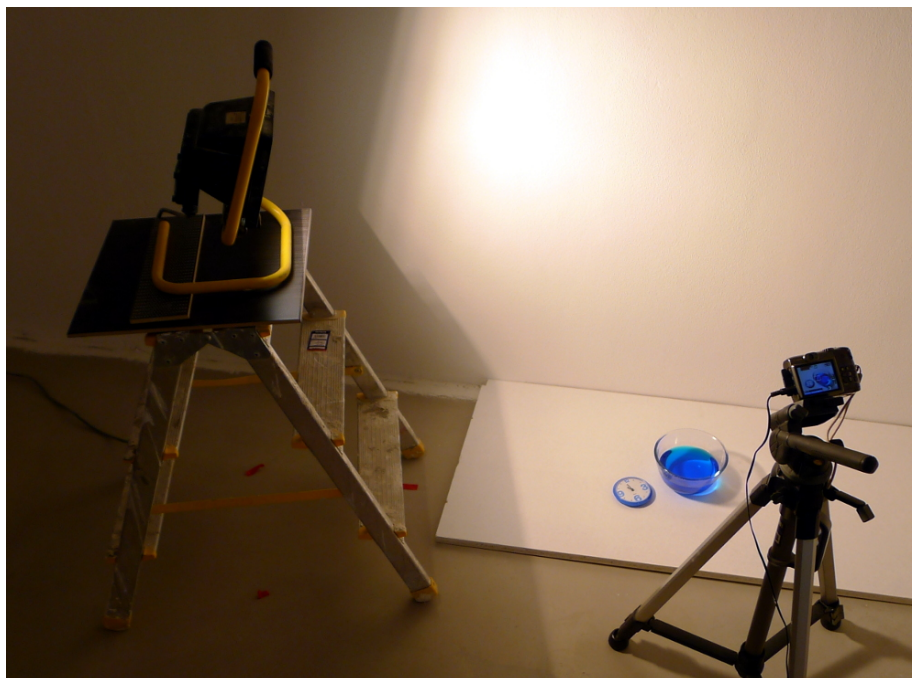
Obrázek 4.8: Osvětlení scény halogenovým reflektorem
