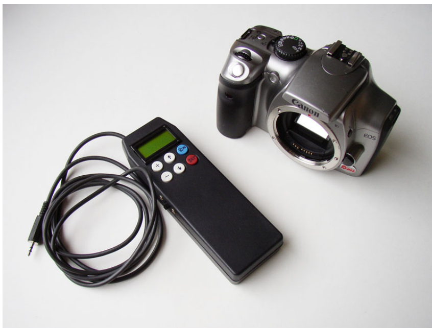
Obrázek 3.5: Fotoaparát s externí kabelovou automatickou spouští Zdroj: http://astrofoto.euweb.cz
