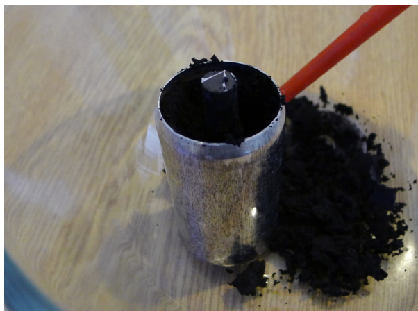
Obrázek 7.8: Vyjmutí uhlíkové elektrody z baterie
