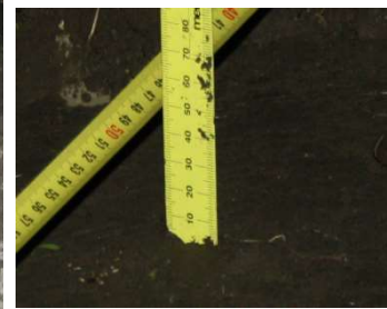
Promáčklina, způsobená zetorem. Bližší záběr na hloubku promáčknutí.
