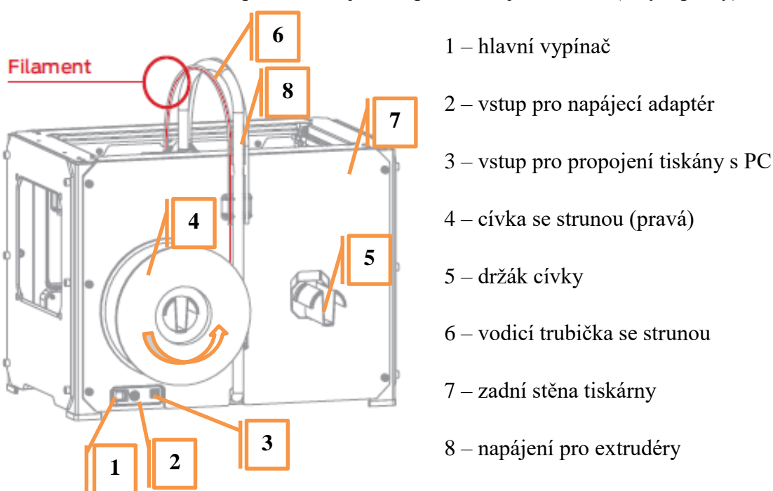
Obrázek 20: Zadní pohled na tiskárnu MakerBot Replicator 2X. Převzato a upraveno z [20]
