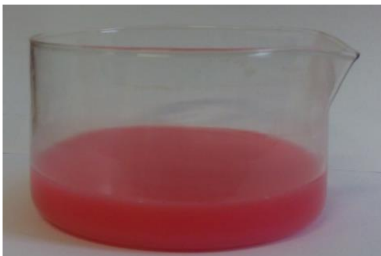
Obrázek 61: Koncentrovaný roztok acetonu a filamentu ABS
