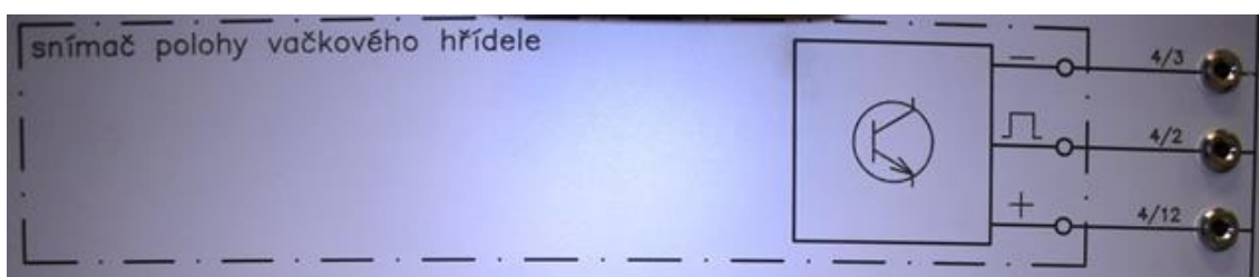
Obr. č. 62 Snímač polohy vačkového hřídele s možností měření elektrických veličin
