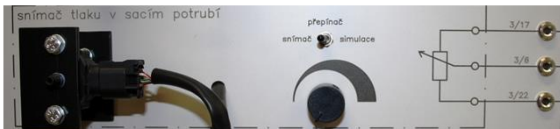
Obr. č. 61 Snímač tlaku v sacím potrubí s možností simulace a měření elektrických veličin
