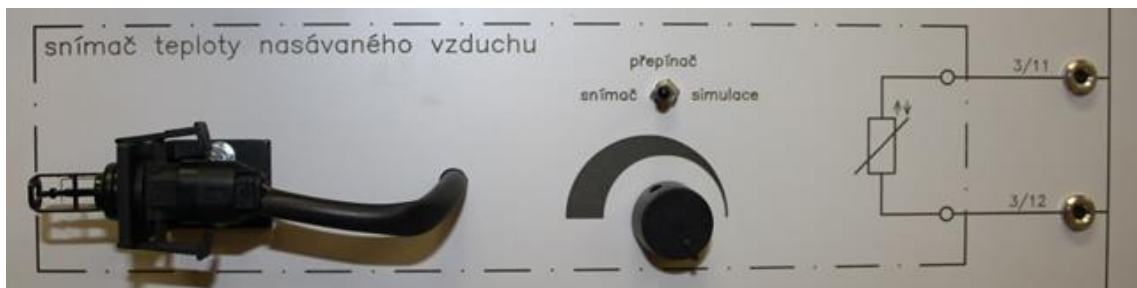
Obr. č. 59 Snímač teploty nasávaného vzduchu s možností simulace a měření elektrických veličin
