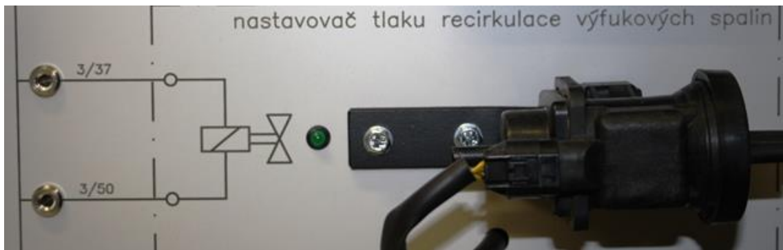
Obr. č. 71 Nastavovač tlaku recirkulace výfukových spalin s možností měření el. veličin
