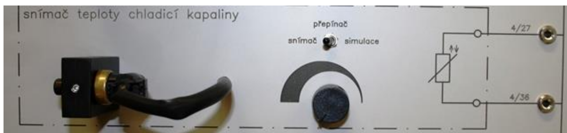
Obr. č. 60 Snímač teploty chladicí kapaliny s možností simulace a měření elektrických veličin
