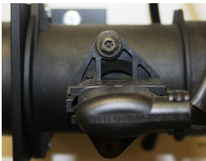
Obr. č. 28 Měřič množství nasávaného vzduchu
