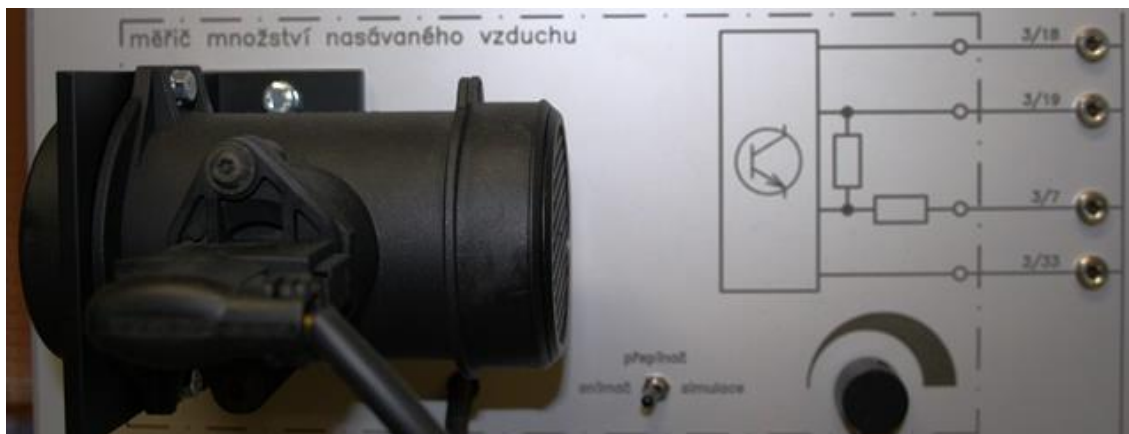
Obr. č. 57 Snímač množství nasávaného vzduchu s možností simulace a měření elektrických veličin
