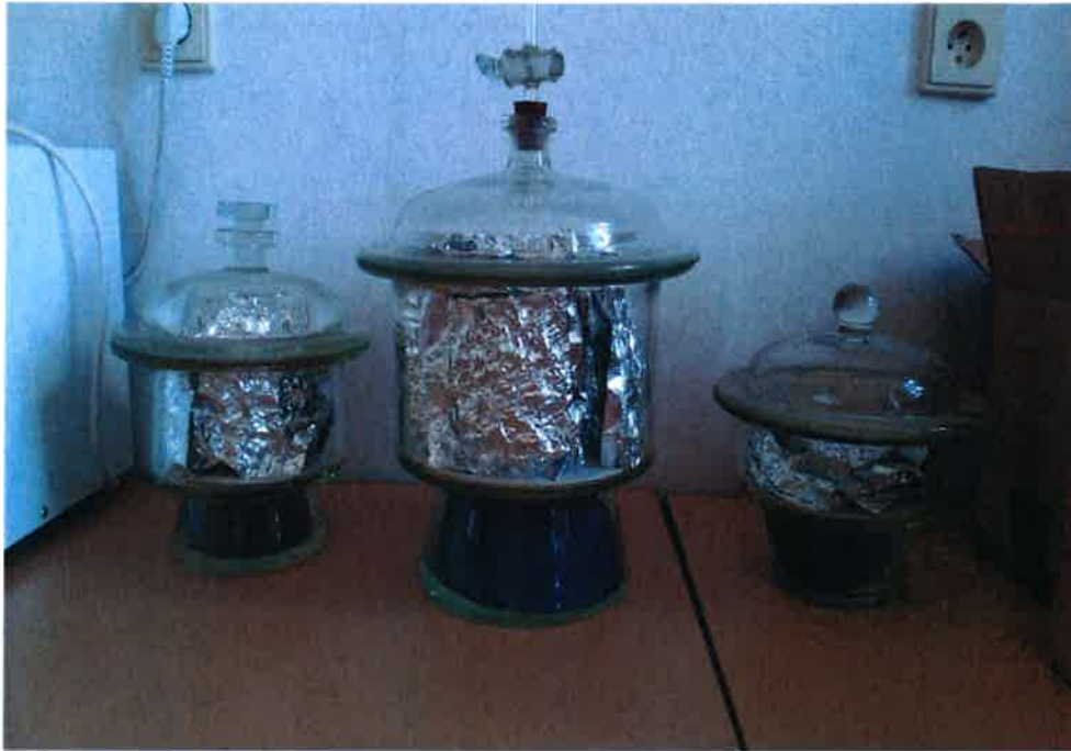
Obr. č. 25 - Obálky s rostlinami po vysušení v exsikátoru
