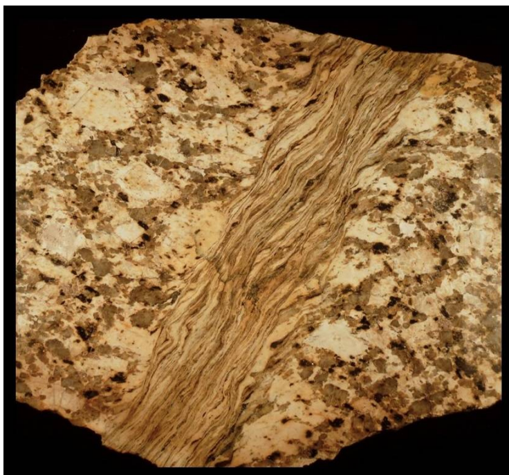
Obrázek 21: Přeměna choustnické žuly na ortorulu (Foto: Moravcová, 2014)
