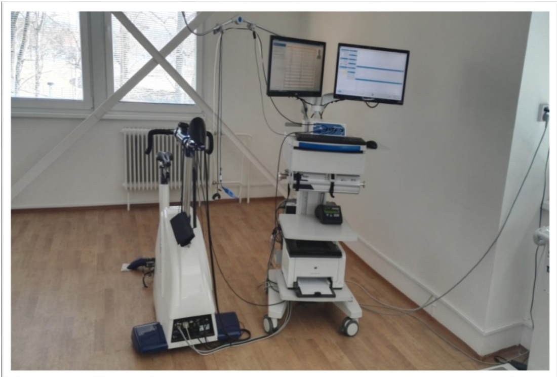
Obrázek č. 2 Ergometr LODE Excalibur Sport, Sestava přístrojů Cortex MetaControl 3000
