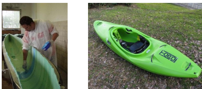
Obrázek 23: Vlevo laminace kánoe a vpravo kompozitní produkt [91], [92]
