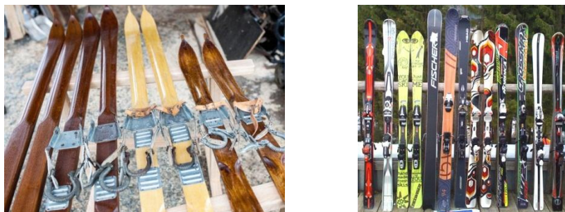
Obrázek 17: Rozdíl mezi dřevěnými a moderními kompozitovými lyžemi (vlevo jasanové lyže (Jasanky) a vpravo kompozitové lyže) [69], [70]
