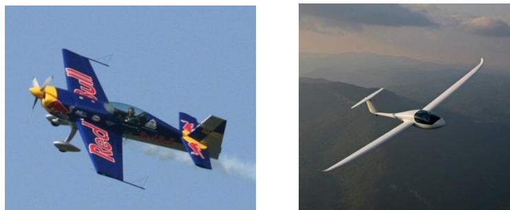
Obrázek 12: Letadla se zcela kompozitovými tělem z CFRP (vlevo závodní letecký speciál a vpravo ultra lehký kluzák) [64], [65]
