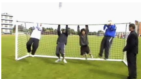
Obrázek 25: Bezpečnost brankové konstrukce při zatížení čtyřmi osobami [96]
