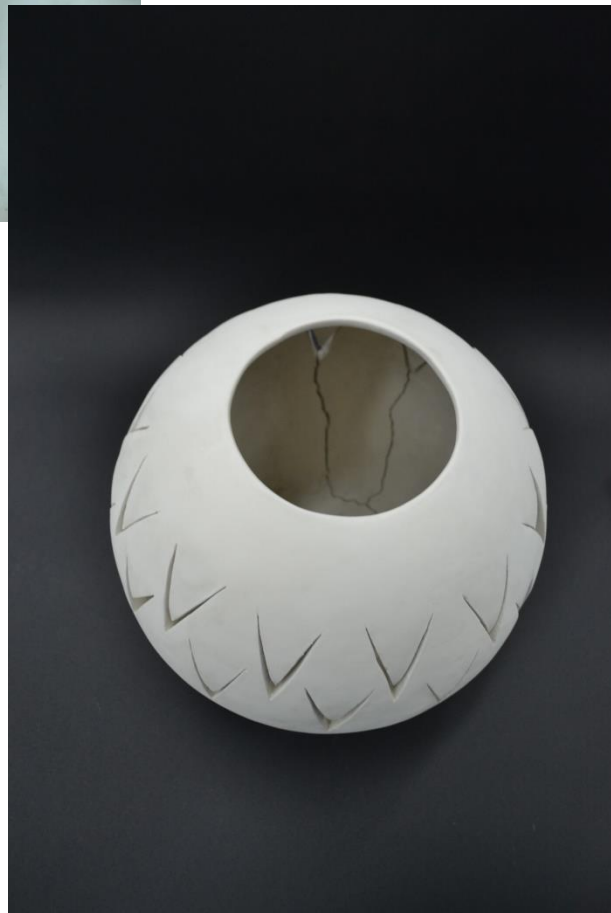
Obr. 6: Váza prasknutá při schnutí.
