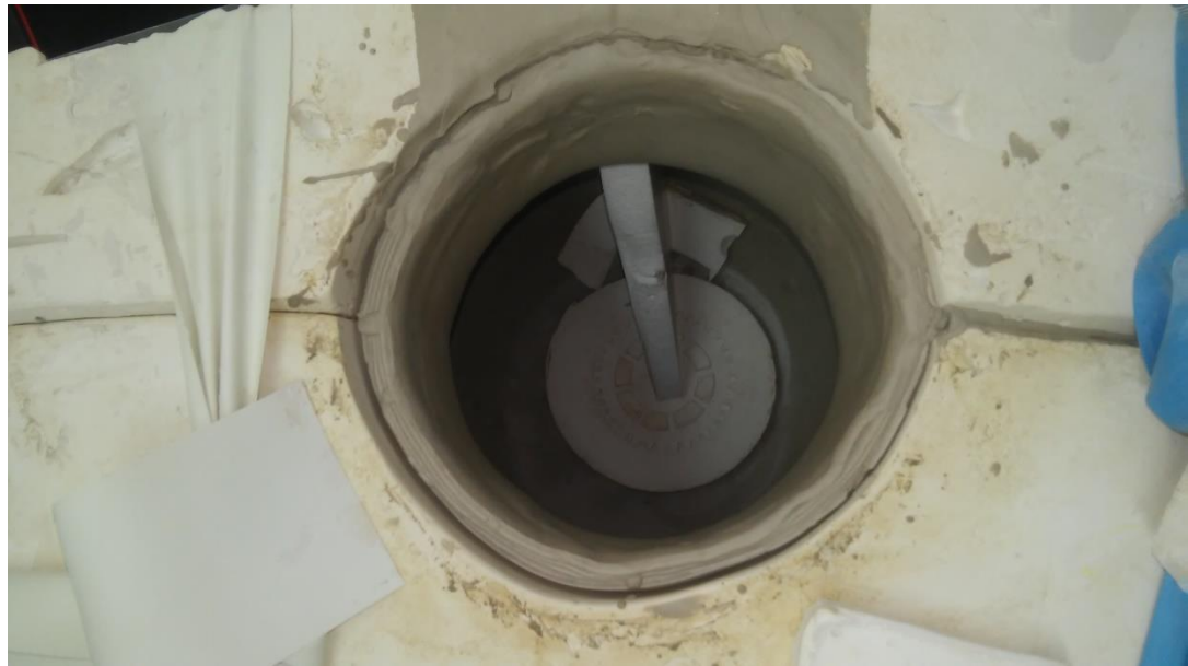
Obr. 4: Další kusy sádry, sají přebytečnou vodu.
