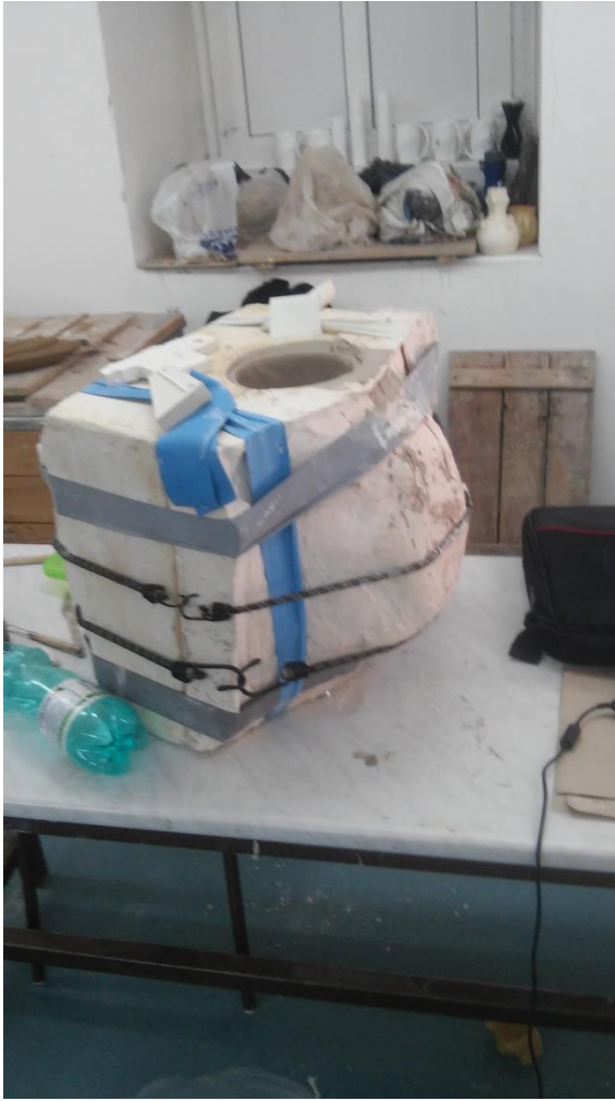
Obr. 4: Další kusy sádry, sají přebytečnou vodu.
