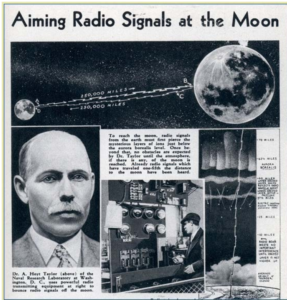
Obr. P48: Počátky radarové astronomie. Dr. Albert. Hoyt Taylor navrhl pokusy založené na vyslání soustředěného úzkého kužele rozhlasových vln, které by po odrazu byly zachyceny citlivým rádiovým přijímačem. Převzato z [48].
