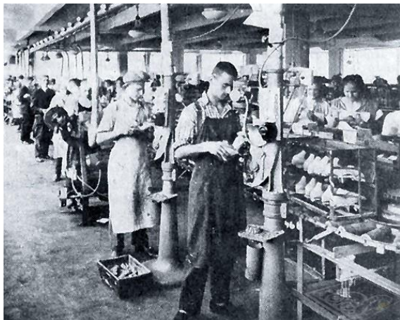
Obr. 1: Výroba dámské obuvi Baťa, stroj k vypalování řezů, 1927.
