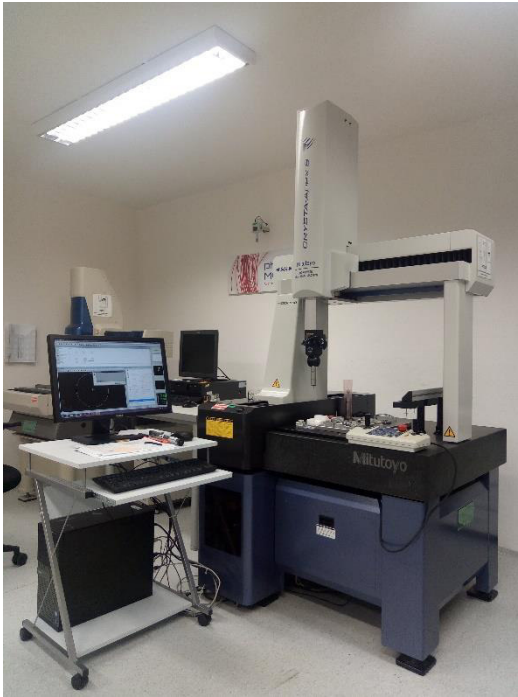
Obr. č. 14 Měřící dotykové zařízení Obr. č. 15 Kloubové rameno dotyku [15] Mitutoyo 3D [14]
