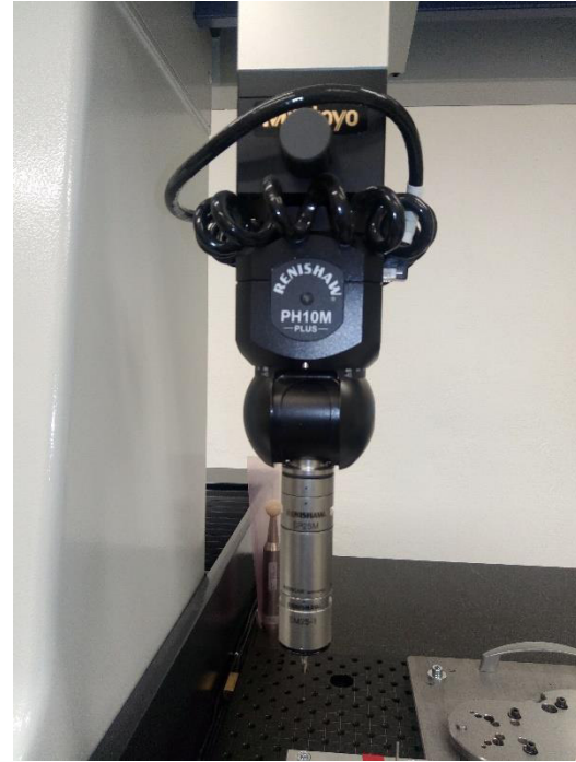
Obr. č. 14 Měřící dotykové zařízení Obr. č. 15 Kloubové rameno dotyku [15] Mitutoyo 3D [14]
