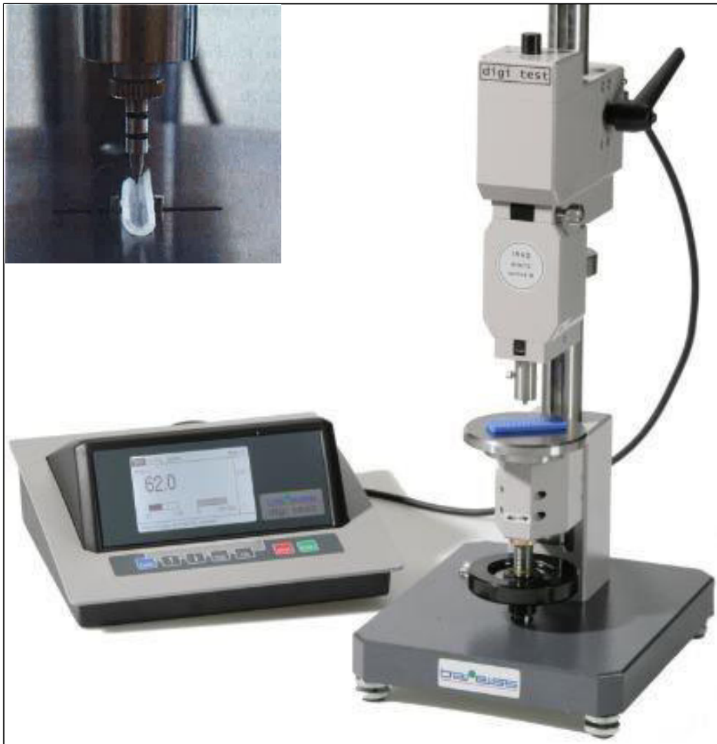
Obr. č. 42 Digitální tvrdoměr Digi test II, ve výřezu je připravený vzorek hadičky pro měření [42]
