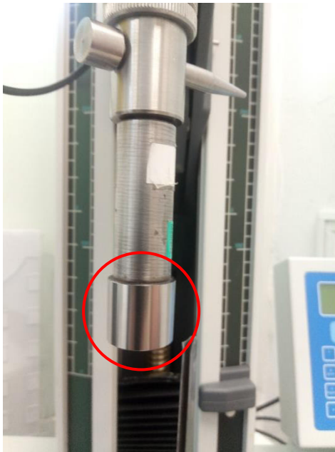
Obr. č. 36 Kalibrovaný kužel - testování vaku [36]
