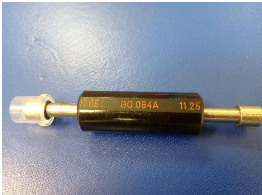
Obr. č. 12 Kalibr na měření vnitřního rozměru 11,5 [mm] u komponentu GO. 064 [12]
