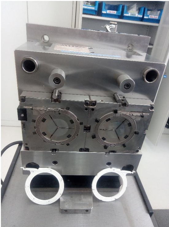
Obr. č. 5 První část vstřikovací formy výrobku SHGF, níže jsou vstřikované komponenty [5] Obr. č. 6 Druhá část vstřikovací formy výrobku SHGF [6]
