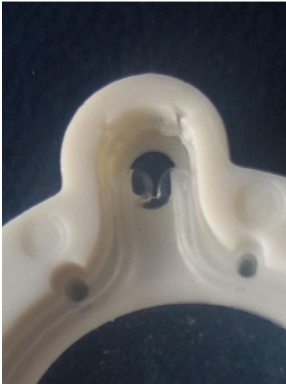
Obr. č. 38 Nedolitý silikon výrobku LP60.00, chybějící část vyznačena červeně [38]
