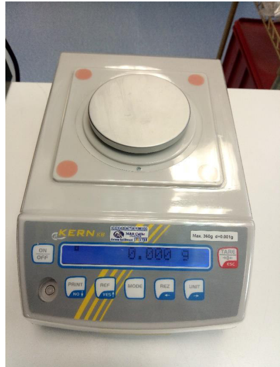
Obr. č. 39 Kontrolní váha vyrobených komponentů na stříkárně [39]
