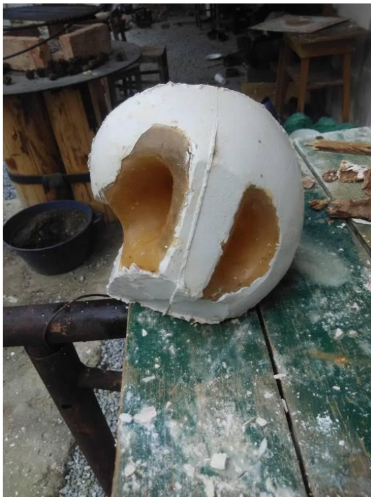
Obr. 26. Odlitek s želatinovými klíny
