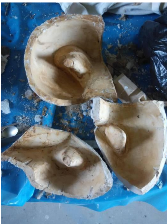
Obr. 22. Díly sádrové části formy
