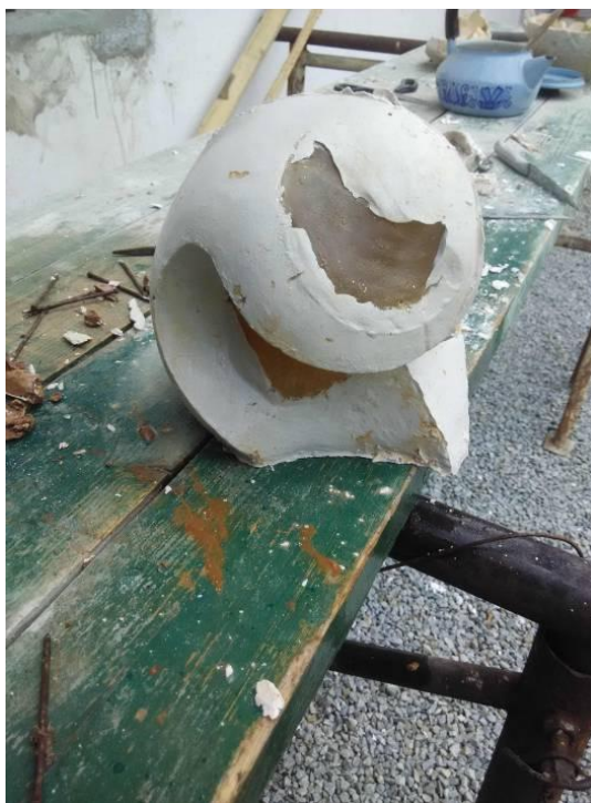
Obr. 25. Odlitek s želatinovými klíny
