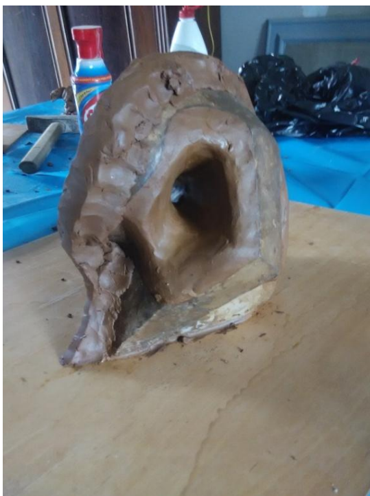
Obr. 21. Hliněná dělicí rovina
