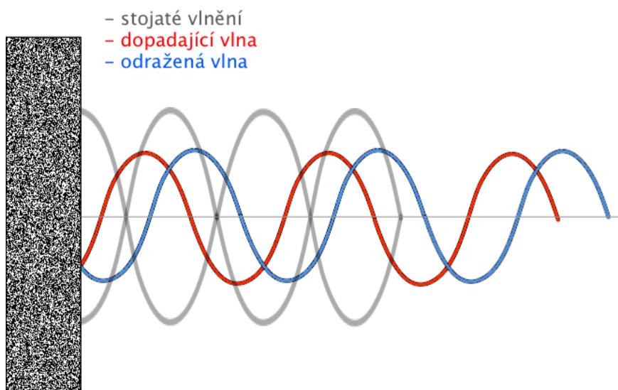
Obrázek 13 Náčrtek odrazu vlny od poddajné překážky
