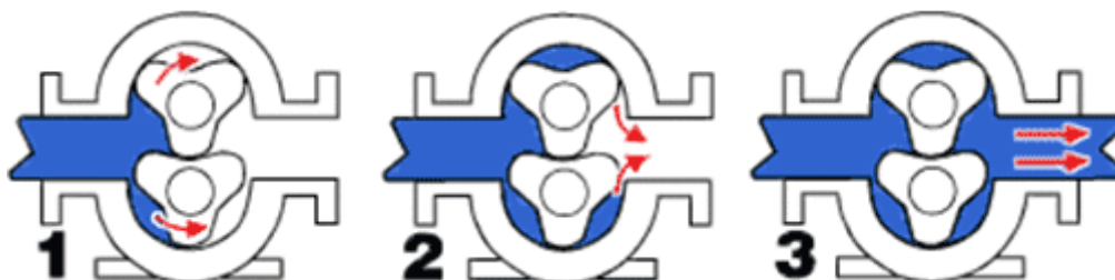
Obrázek 7 Jednotlivé fáze TRI-Lobe čerpadla
