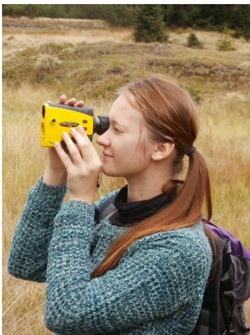
Obr. 2: Měření laserovým dálkoměrem v terénu.
