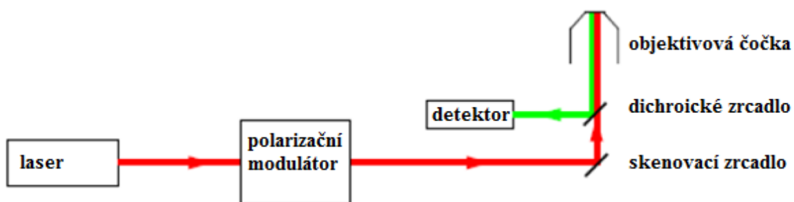
Obr. 6: Schéma dvoufotonového polarizačního mikroskopu.
