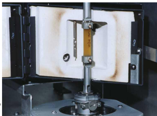
obr. 5.4: Frekvenční analýza DMA TSCP [0], ilustrační umístění vzorku v DMA analyzátoru [15]
