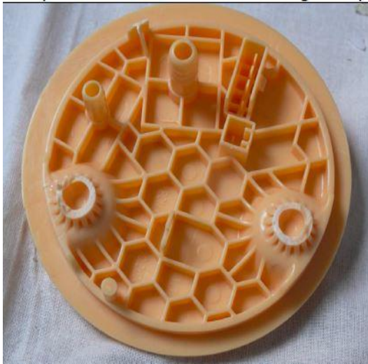
obr. 1.4: Správně odlomená příruba - těsná [0]
