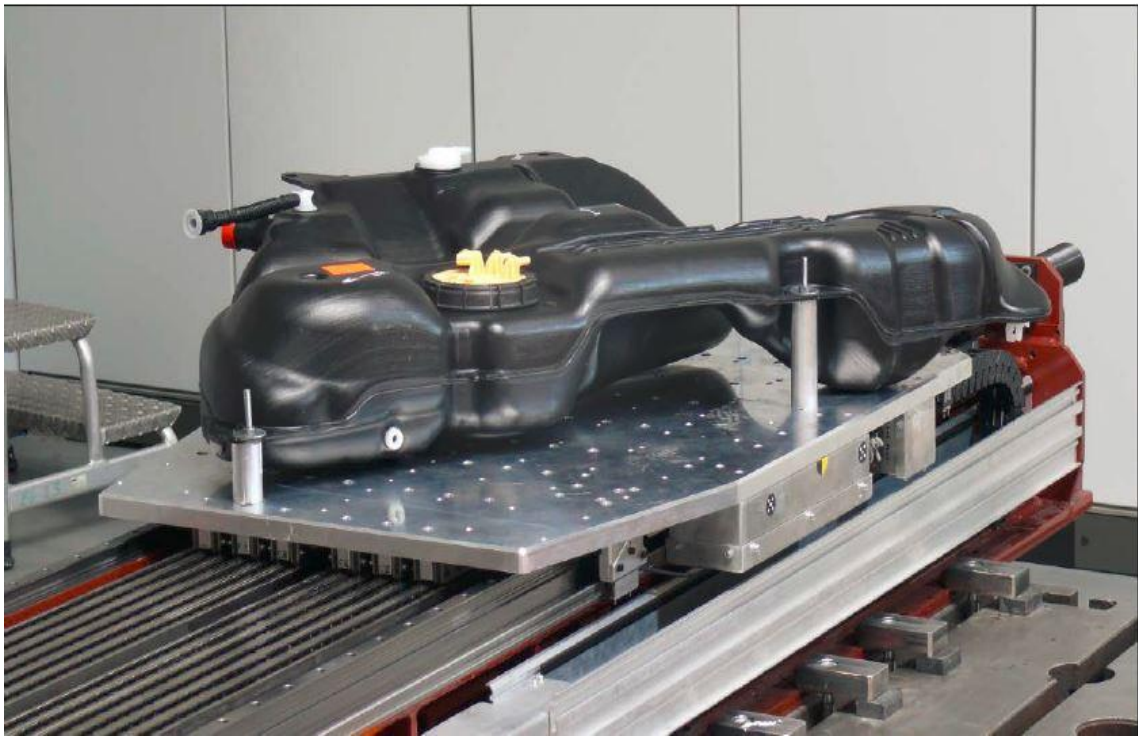
obr. 1.3: Saňový test – nádrž s FSM na testovacím zařízení [0]
