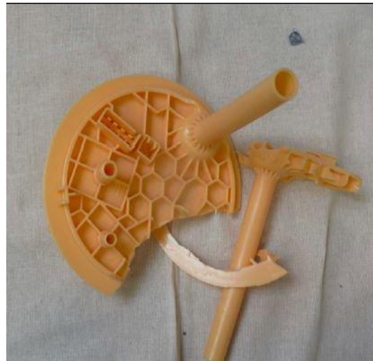
obr. 1.5: Nesprávně odlomená příruba - netěsná [0]
