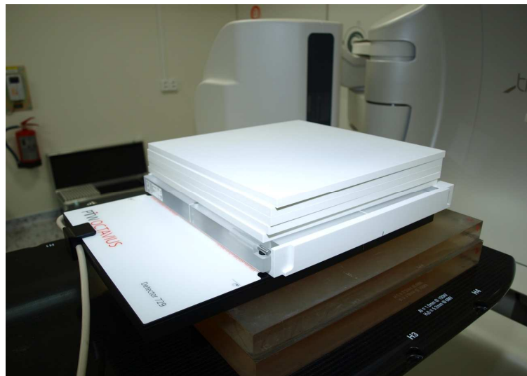
Obrázek 2 Fantom 2D pole detektorů s deskovým fantomem RW3
