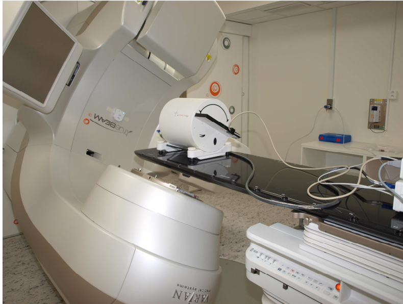
Obrázek 5 – lineární urychlovač propojen s fantomem OCTAVIUS
