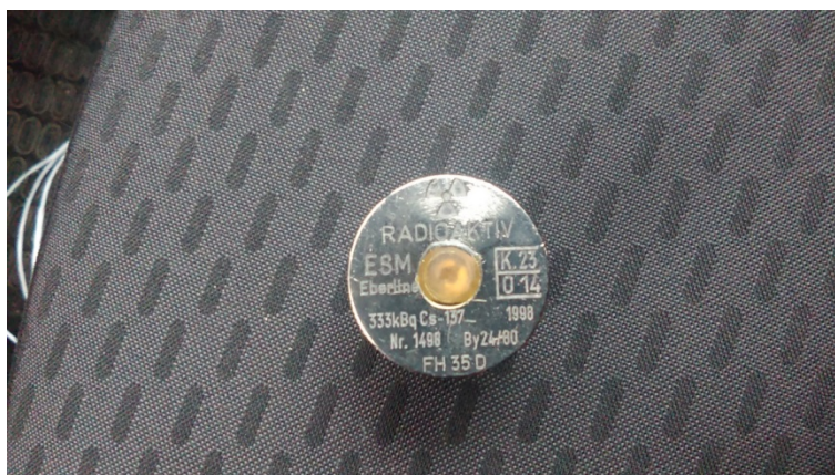
Obrázek 20: Foto použitého zářiče ^{137}\text{Cs} (ke dni měření 223,458 kBq)
