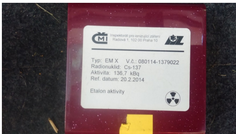
Obrázek 16: Foto použitého zářiče ^{137}\text{Cs} (ke dni měření 130,7 kBq)
