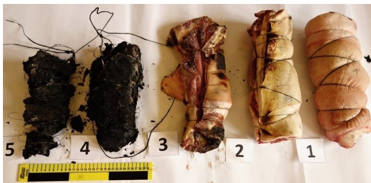
Obrázek 26 – Porovnání poškození všech vzorků po zkoušce (poznámka: vzorky č. 4 a 5 se zbytky textilií a měřicích čidel), zdroj: vlastní výzkum
