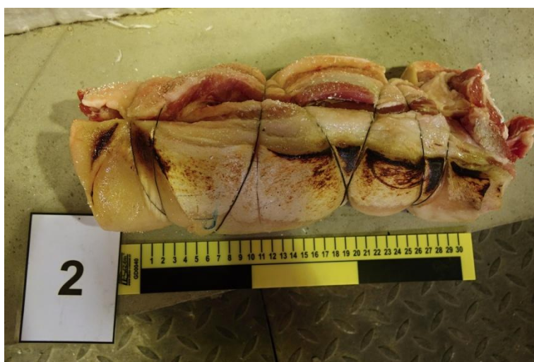
Obrázek 7 - Vzorek č. 2 po provedení zkoušky, na spoji vzorku patrné okrajové zuhelnatění vrchních vrstev tkáně, zdroj: vlastní výzkum
