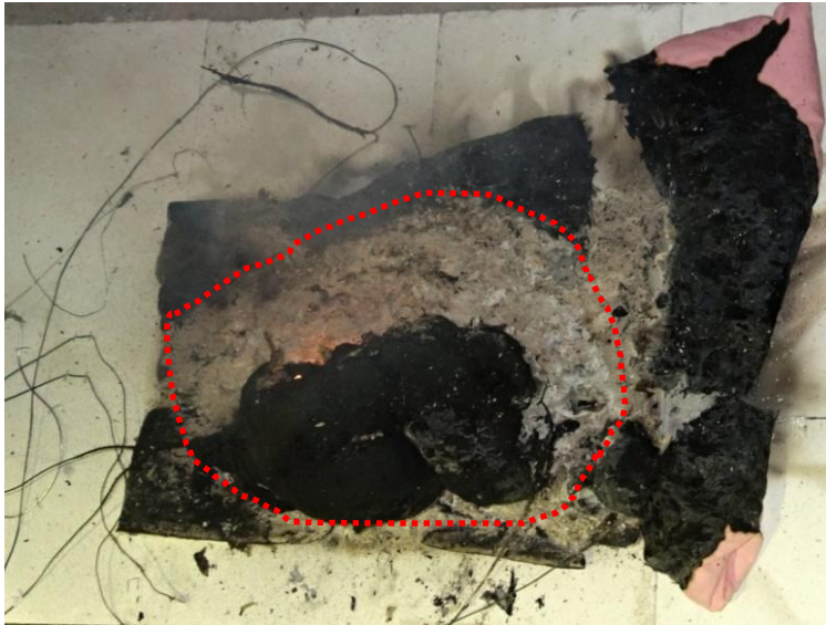
Obrázek 22 – Vzorek č. 5 v průběhu zkoušky s červeným vyznačením největšího poškození dřevěné podložky, zdroj: vlastní výzkum
