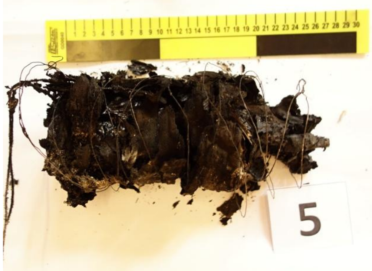
Obrázek č. 20 – Vzorek č. 5, stav po ukončení hoření a celkovém ochlazení, zdroj: vlastní výzkum
