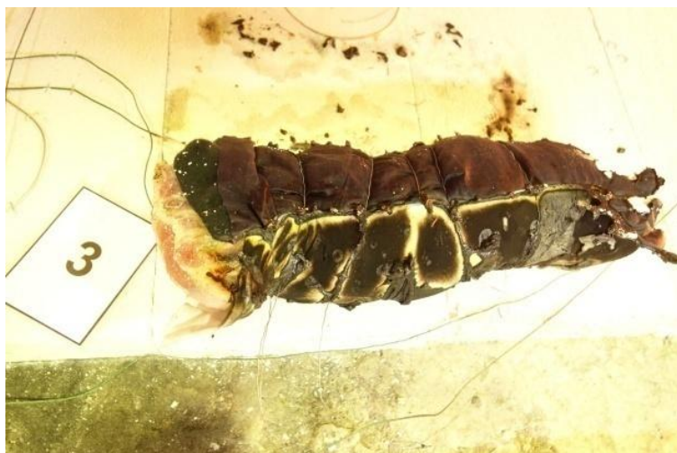
Obrázek 12 – Poškození textilií vzorku č. 3 po ukončení hoření ve spodní části zdroj: vlastní výzkum
