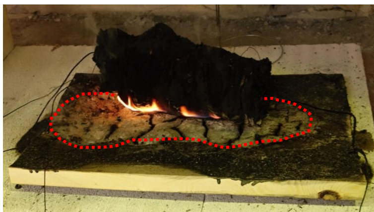
Obrázek 16 – Vzorek č. 4 v průběhu zkoušky (s vyznačením největšího poškození dřevěné podložky), zdroj: vlastní výzkum
