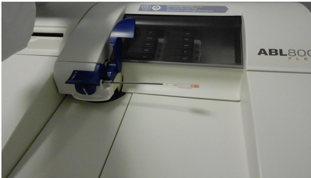
Obrázek 6: Nasávání krve z kapiláry přístrojem ABL 800 FLEX. Zdroj: autor.
