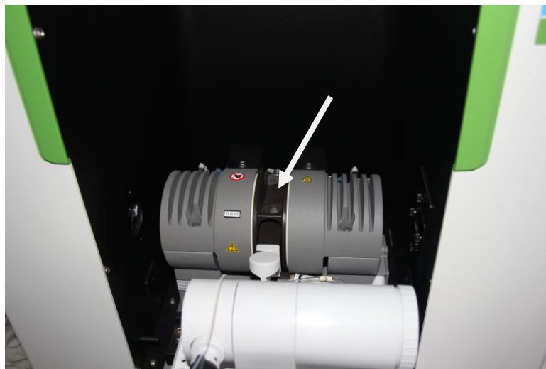
Obr. č. 7: Prostor pro dávkování vzorku do grafitové kyvety.
