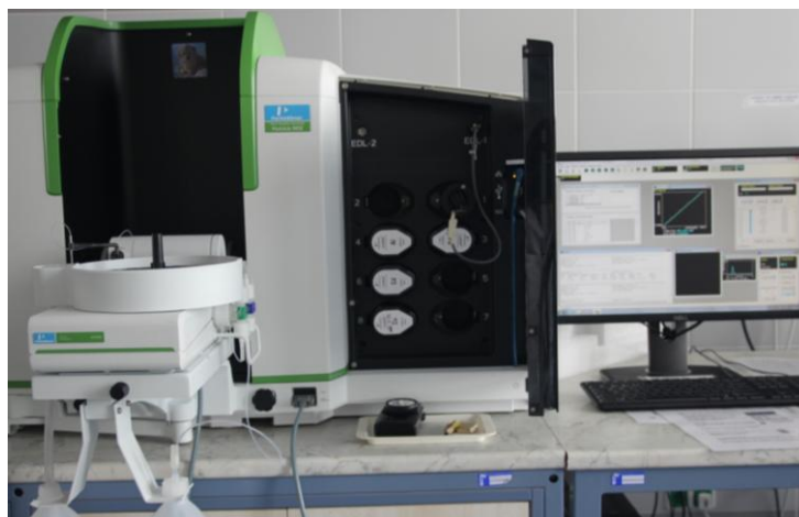
Obr. č. 6: Atomový absorpční spektrofotometr PinAAcle 900 Z firmy Perkin Elmer.
